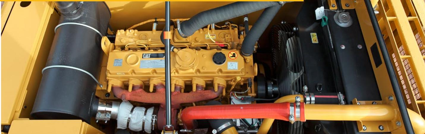
Cat C7.1 发动机配有机械调节式燃油系统，符合美国 Tier 3、欧盟 Stage IIIA 等效排放标准以及中国非公路用车辆 Stage III 排放标准。这款发动机动力强劲、坚固耐用，可满足您所有的应用需求。对于想节省燃油的客户，省油-模式功能可节省多达 15% 的油耗。C7.1 发动机融合了久经考验、坚固耐用的部件和精密的制造工艺，确保能够可靠、高效地运行。此外，这款发动机还对品质欠佳的燃油不太敏感，因此进一步降低了油耗。
