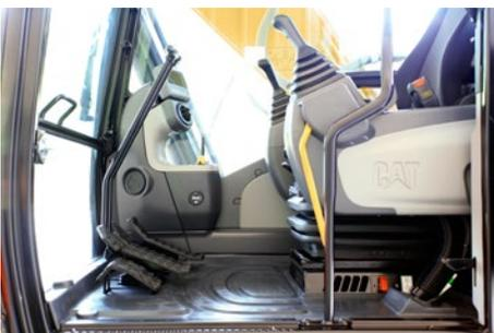
Le **levier de sécurité hydraulique** standard inhibe toutes les fonctions hydrauliques et de translation lorsqu'il est en position abaissée. Il est spécifiquement conçu pour que le conducteur ne puisse pas quitter la cabine sans l'avoir abaissé.
