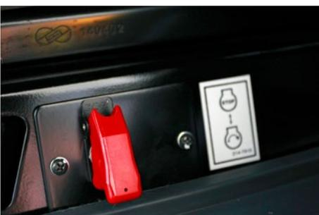
Lorsqu'il est activé, le **contacteur d'arrêt** au niveau du sol interrompt l'alimentation du moteur en carburant et arrête la machine.
