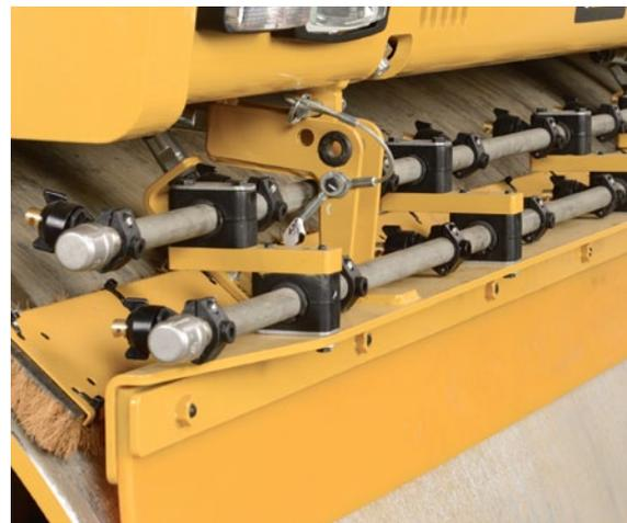
*Las dos barras de rociado de los modelos CB64B, CB66B y CB68B contribuyen a garantizar que los tambores se mantengan húmedos, incluso en condiciones extremas.*
