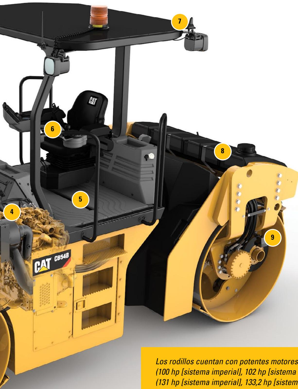
*Los rodillos cuentan con potentes motores Cat, de entre 75 kW (100 hp [sistema imperial], 102 hp [sistema métrico]) y 98 kW (131 hp [sistema imperial], 133,2 hp [sistema métrico]).*
