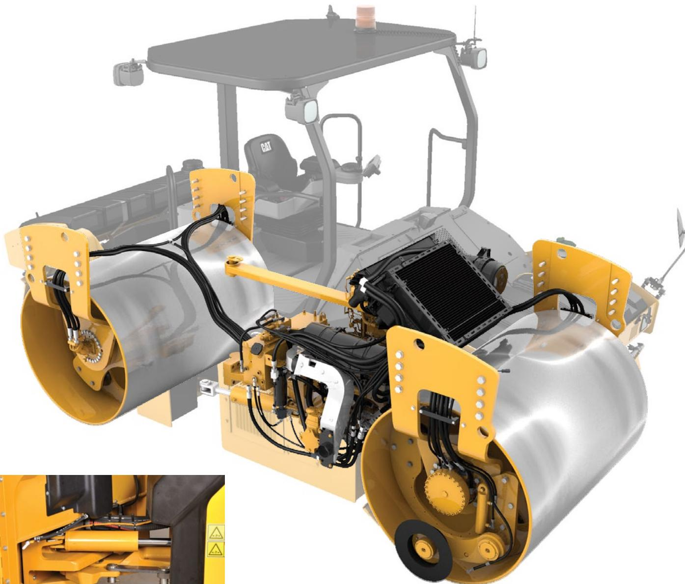
*El diseño oscilante del enganche mejora la calidad de la conducción en terrenos irregulares.*
