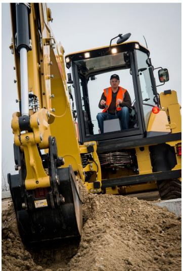
Der 428F2 verfügt über leichtgängige mechanische Steuerungen, bei denen zwischen ISO-Schaltschema (Bagger) oder SAE-Schaltschema (Heckbagger) gewählt werden kann. Ermöglicht allen Fahrern unabhängig von ihrem Erfahrungsoder Kompetenzlevel einen einfachen und sicheren Betrieb.
