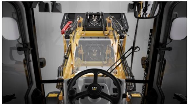
Der 432F2 verfügt über leichtgängige Vorsteuerungen, bei denen auf Tastendruck zwischen ISO-Schaltschema (Bagger) oder SAE-Schaltschema (Heckbagger) umgeschaltet werden kann. Ermöglicht allen Fahrern unabhängig von ihrem Erfahrungs- oder Kompetenzlevel einen einfachen und sicheren Betrieb.
