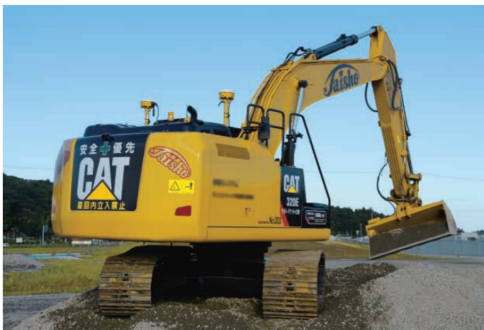
CATグレードコントロールを搭載した320E。チルトバケット仕様の国内第1号機です。
