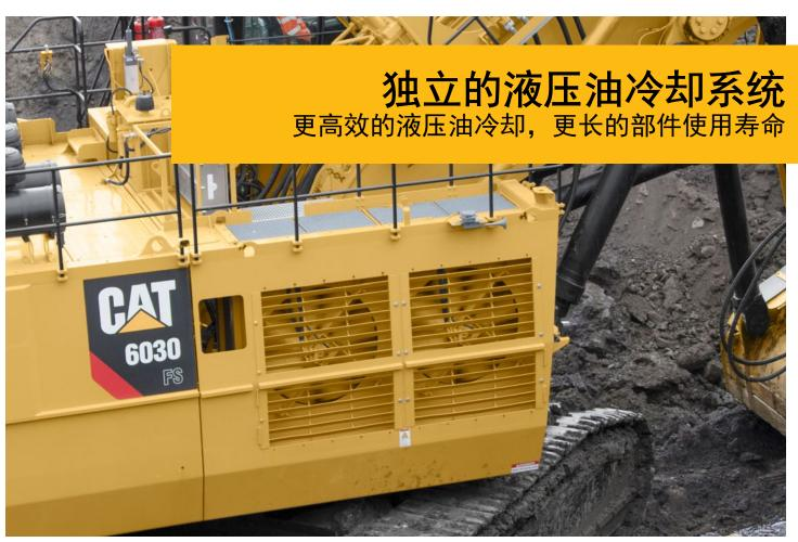
**通过智能泵管理系统,不但可以改善机器操控性和延长部件使用寿命,而且还能降低油耗和噪音** 泵管理系统持续不断地根据设定值来评估实际的发动机及液压系统运行数据,并且相应调节泵的输出来提供最佳性能。 这样就能够有效使用发动机,获得更高的生产率。
