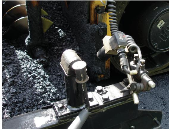
Los sensores sónicos de alimentación emiten pulsos de sonido que rebotan en el material que sale de la cámara del sinfín y regresan hacia el sensor.
