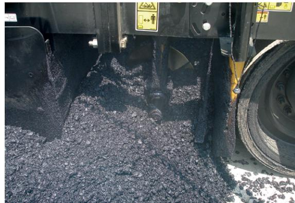
Los sensores mecánicos de alimentación tienen contacto con el material a medida que fluye hacia la cámara del sinfín.
