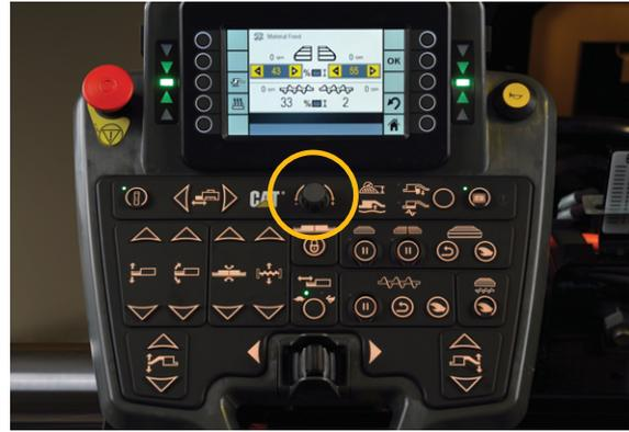
Los diales de altura de la mezcla de los paneles de control del reglón regulan la carga de material en los extremos de las barras del sinfín.
