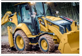
Le modèle 432F2 est doté de commandes entièrement asservies pour un fonctionnement sans effort. Il est possible de choisir entre la grille de commande de la pelle rétro (SAE) et celle de la pelle hydraulique (ISO) en appuyant sur un simple bouton. Elle offre un accès facile et sûr aux conducteurs, quelle que soit leur expérience ou leur capacité.
