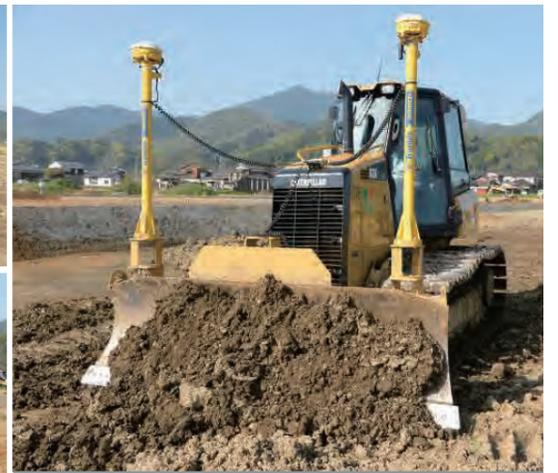
CATグレードコントロール(マシンコントロール)を搭載したD3K2
