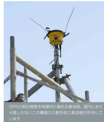
GPSの測位精度を飛躍的に高める基地局。国内にまだ4基しかないこの機器の2基を政工務店様が所有しています
