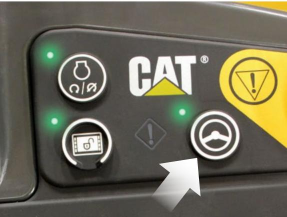
*La configuración de la máquina se transfiere automáticamente entre estaciones; solo presione el botón para reanudar la pavimentación.*
