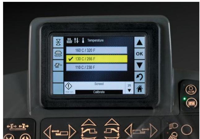
**Tres opciones de calentamiento predeterminadas proporcionan una amplia gama de temperaturas para diferentes diseños de mezcla.**
