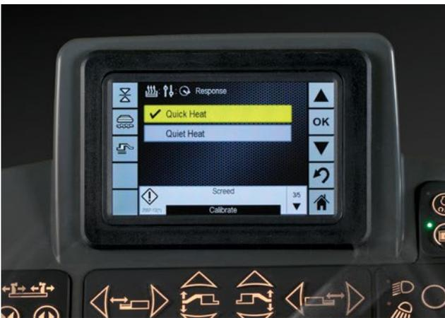
**El calentamiento rápido o silencioso se puede seleccionar fácilmente a través de la pantalla LCD. El calentamiento rápido ofrece ahorros de tiempo si se utilizan paquetes de ancho amplio.**
