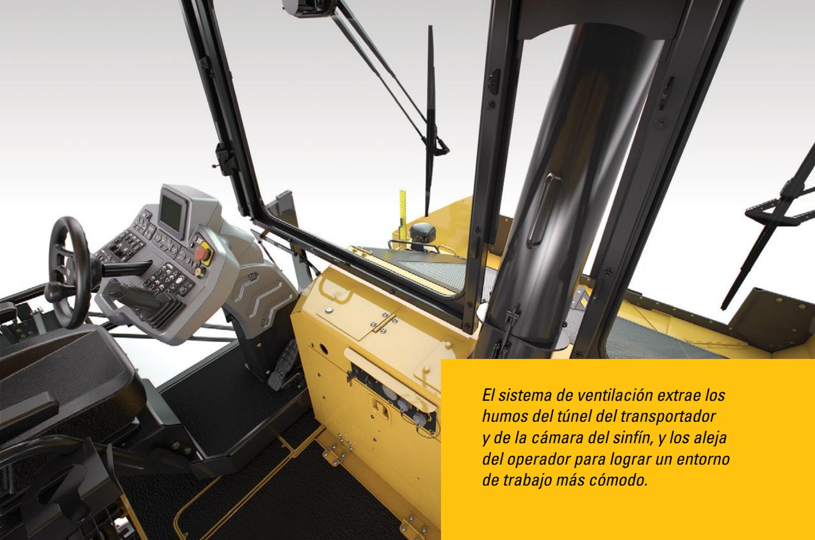
*El sistema de ventilación extrae los humos del túnel del transportador y de la cámara del sinfín, y los aleja del operador para lograr un entorno de trabajo más cómodo.*
