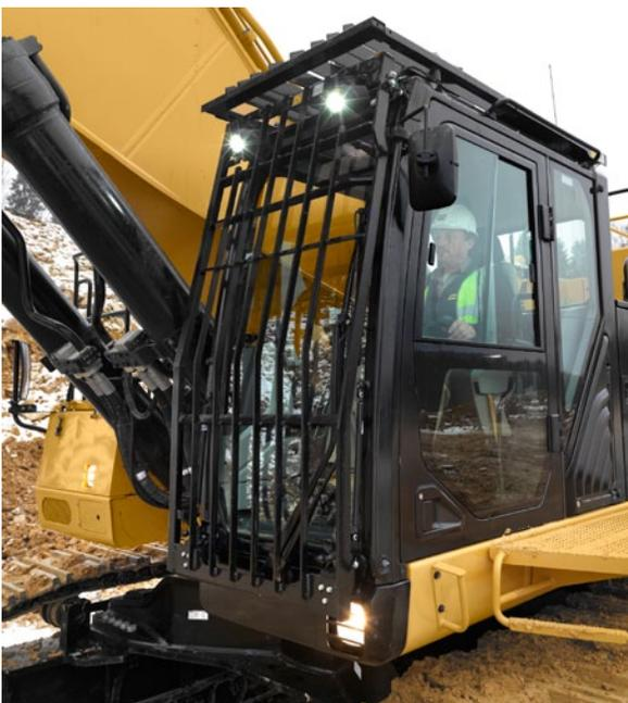
Le luci alogene forniscono notevole illuminazione. Le luci cabina e braccio possono essere programmate per rimanere accese fino a un massimo di 90 secondi dopo lo spegnimento del motore, per agevolare l'uscita in sicurezza dalla macchina. Luci opzionali a scarica ad alta intensità (HID, High Intensity Discharge) sono disponibili per una migliore visibilità notturna.
