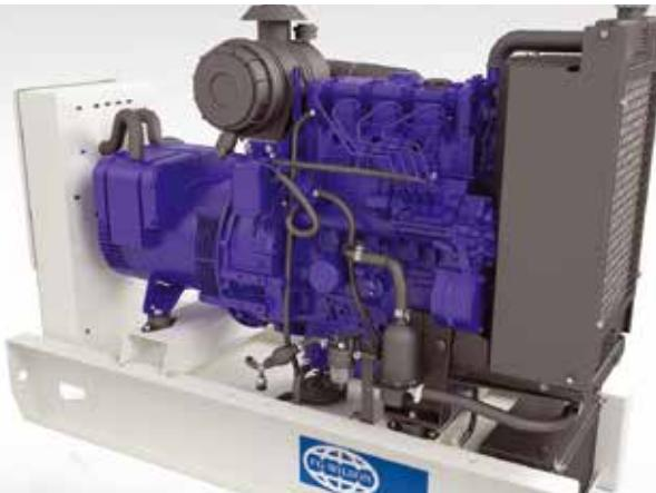
Доступ к топливному и масляному фильтрам, а также к резервуару с охлаждающей жидкостью расположен с одной стороны, что существенно сокращает время, затрачиваемое на техническое обслуживание, и повышает производительность генераторной установки. Заливная горловина топливного бака расположена рядом с датчиком уровня топлива на противоположной стороне бака, благодаря чему заливать топливо и контролировать его уровень стало еще проще.
