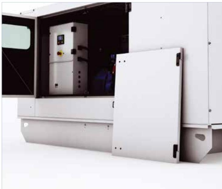
Portas laterais articuladas, em cada lado da caixa, fornecem um amplo acesso a todos os componentes necessários durante a instalação e manutenção. As dobradiças de içamento permitem que as portas sejam removidas a um ângulo de 90°, facilitando a manutenção em espaços confinados,
