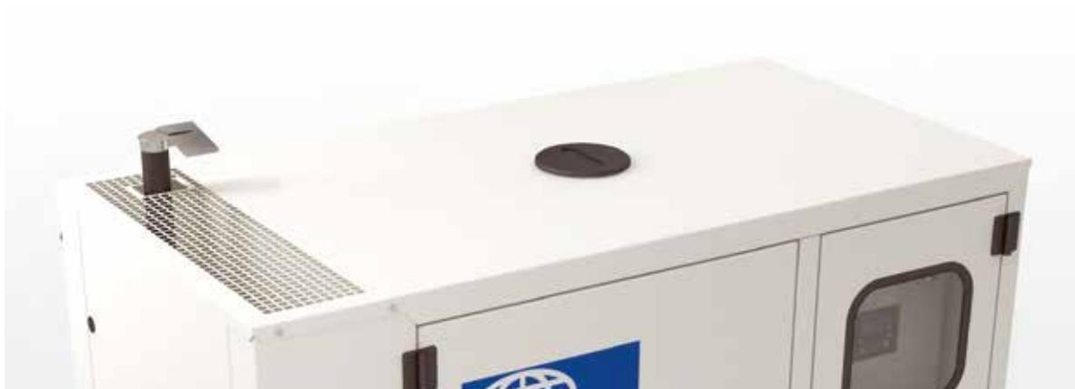
Le toit monobloc robuste comprend un couvercle d'accès en arasement muni d'un joint de compression, permettant l'accès à l'anneau de levage central, tout en assurant une excellente protection contre les pénétrations d'eau. Le système d'échappement silencieux est logé dans le capotage, pour offrir des niveaux sonores parmi les meilleurs du marché tout en garantissant la sécurité de l'opérateur.
