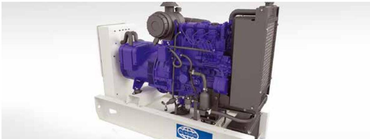
L'accès au filtre à carburant, au filtre à huile et au liquide de refroidissement se fait par un seul côté, pour permettre un temps de maintenance minimal et une disponibilité maximale du groupe électrogène. L'orifice de remplissage de carburant et la jauge à carburant se trouvent tous deux de l'autre côté du réservoir de carburant pour un remplissage et un contrôle aisés.
