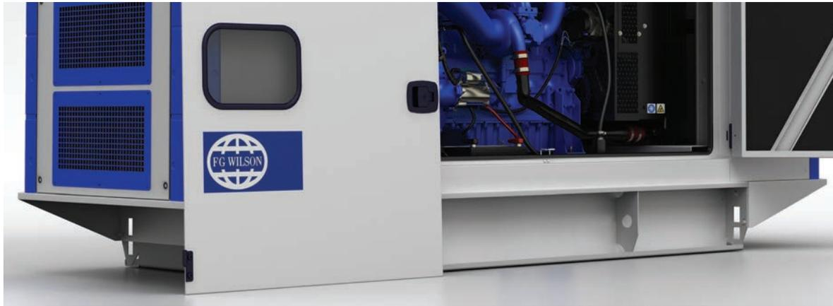
Seitlich eingehängte Türen an beiden Seiten des Gehäuses bieten bei Installation und Wartungsarbeiten einen einfachen Zugang zu allen erforderlichen Komponenten. Dank der aushängbaren Angeln können die Türen sogar in einem Winkel von 45° vollständig abgenommen werden, was Wartungsarbeiten in einem beengten Umfeld erheblich erleichtert.
