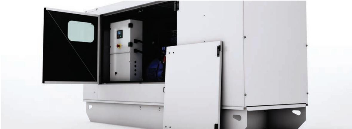
Seitlich eingehängte Türen an beiden Seiten des Gehäuses bieten bei Installation und Wartungsarbeiten einen einfachen Zugang zu allen erforderlichen Komponenten. Dank der abnehmbaren Scharniere können die Türen in einem Winkel von 90° entfernt werden, was auch in beengten Umgebungen für eine einfache Wartung sorgt.
