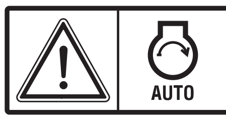
Предупреждение об автоматическом пуске
