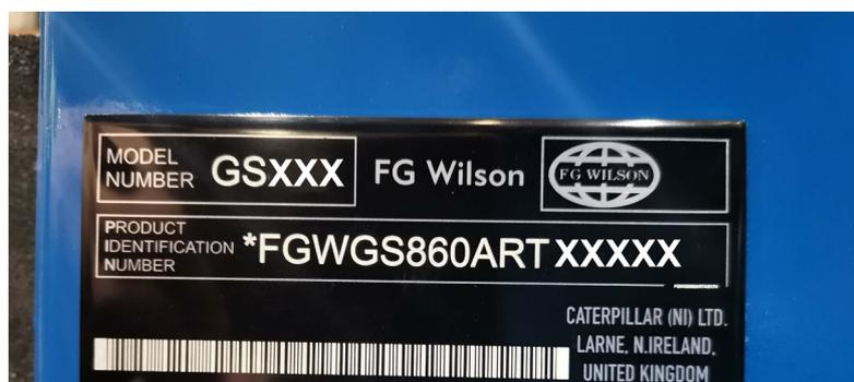
Figura 3.1: placa de PIN típica
