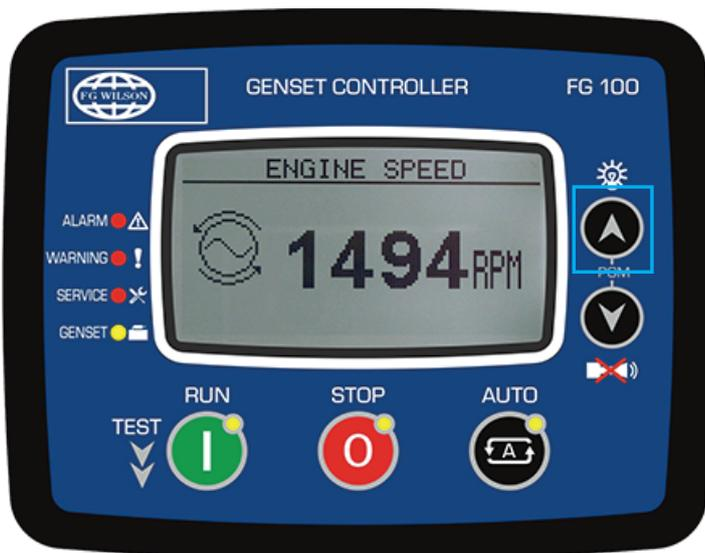
El modo de programa se usa para ajustar los temporizadores, los límites operativos y la configuración de la unidad. Aunque se proporciona un programa PC para la programación, todos los parámetros se pueden modificar en el panel frontal, independientemente del modo operativo.
