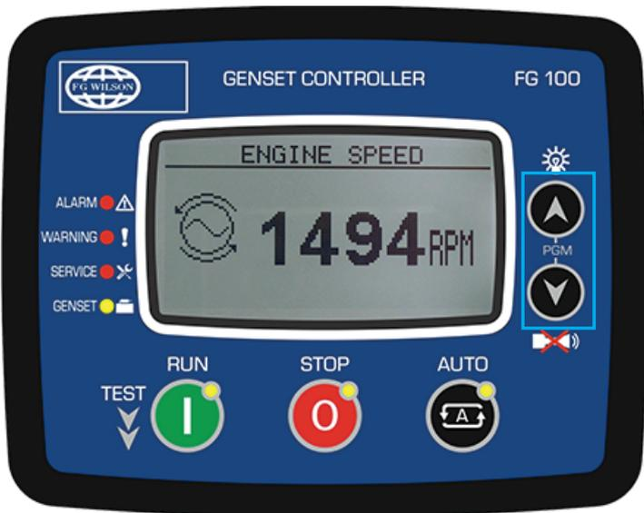
按下▲▼按钮4次可跳过密码输入屏幕。此时将显示左下方的屏幕。
