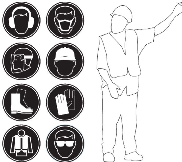
图2.1 - 操作人品需佩戴的典型个人防护设备
