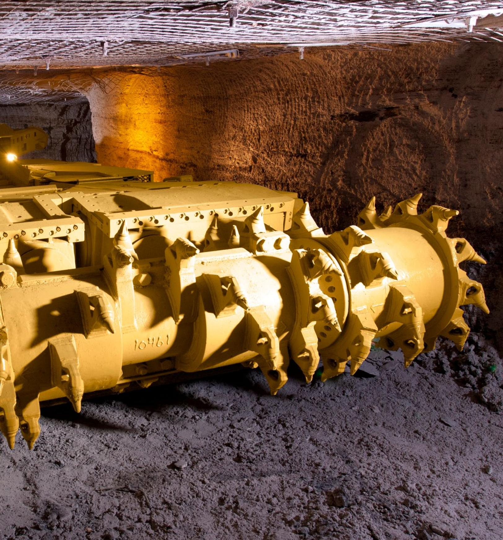
**Con un peso de 61,2 toneladas métricas (135.000 lb) y con un diseño compacto específico para operaciones en mantos bajos a medios, el Minero Continuo Cat CM235 incorpora todas las características robustas de la serie CM200, además de nuevas características y mejoras. Con dos motores de 205 kW (2 × 275 hp) en el cabezal cortador, es el minero continuo más potente en su clase.**
