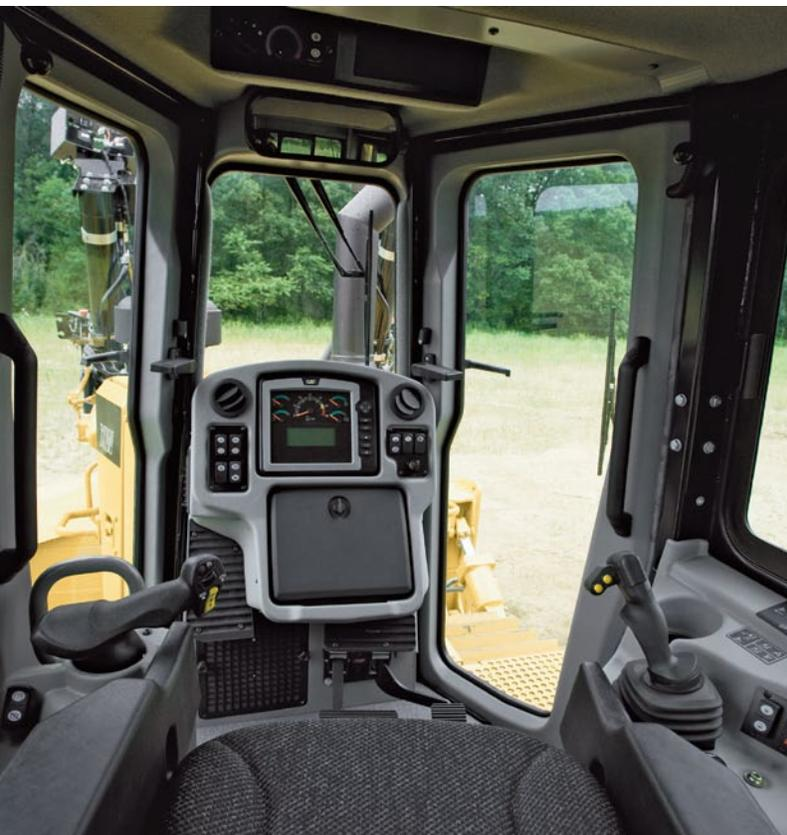
La cabina del modelo D6T está diseñada y equipada para la productividad, la seguridad y la comodidad del operador. La cabina montada con aisladores reduce el ruido y la vibración. Las grandes ventanas de un solo vidrio, el capó inclinado hacia adelante y el tanque de combustible entallado proporcionan una excelente visibilidad para todos los lados de la máquina y alrededor del lugar de trabajo.
