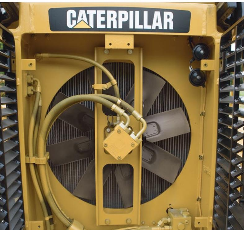
El radiador del motor, el posenfriador de aire a aire (ATAAC) y el enfriador de aceite hidráulico están empaquetados en un plano sencillo. La construcción de la placa de barras de aluminio proporciona durabilidad y permite una mayor transferencia de calor y una superior resistencia a la corrosión. Los núcleos estándar cuentan con 6 aletas por pulgada para permitir que la suciedad pase por ellos y reducir las preocupaciones de taponamiento.
