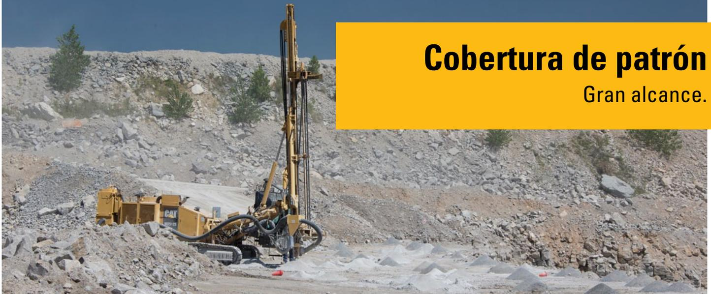
**Para adaptarse a las limitaciones de altura o terreno irregular, la alimentación de 3,66 m (12') y la pluma telescópica de servicio pesado de 2,6 m (8,5') del modelo MD5125 C entrega un régimen de operación más bajo y se extiende 0,9 m (3') adicionales cuando es necesario. El modelo MD5125 CL siempre está listo para operar con su pluma no telescópica de 2,8 m (9').**
