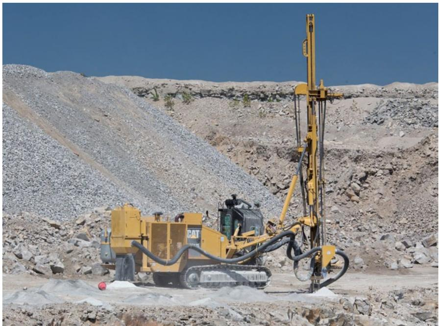
***La mayor longitud de la pluma y de la alimentación es ideal para perforación de orificios profundos con pocos cambios de varilla. La pluma es fija y lista para operar.***
