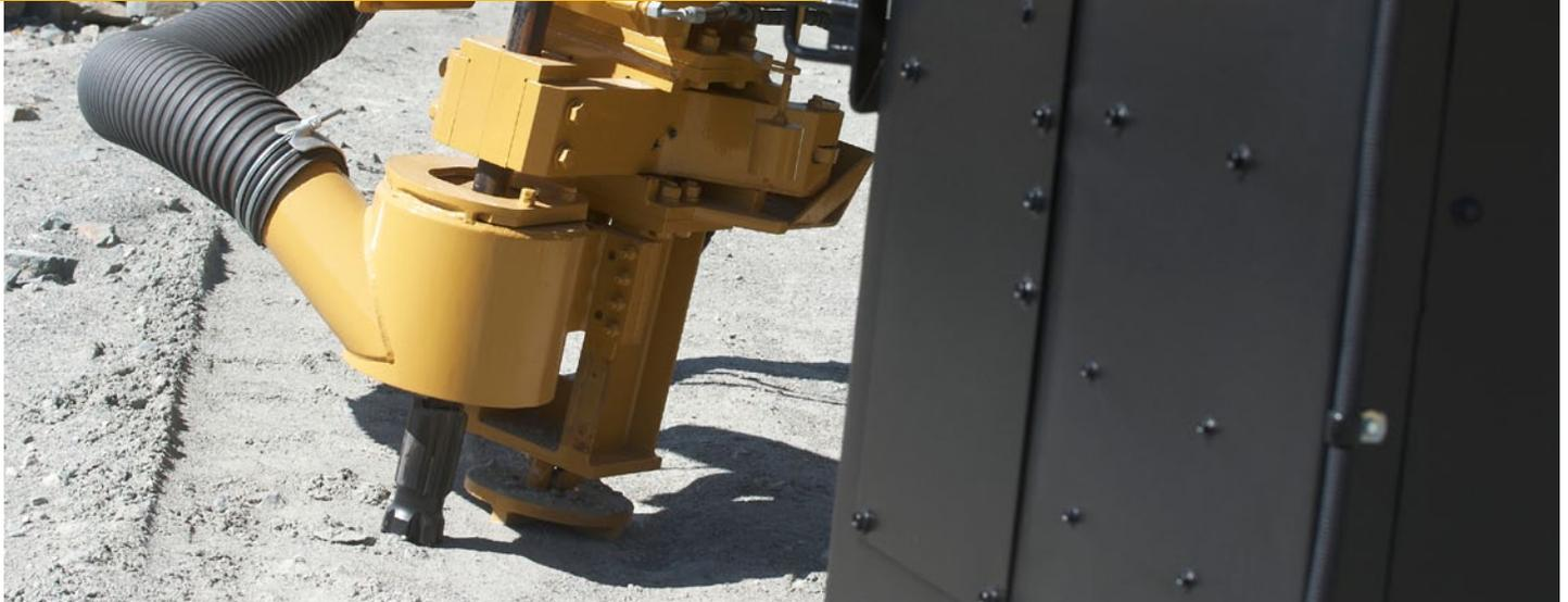
***El Recolector de Polvo Cat HDE 1200 es sólido y eficiente. Potenciado para limpiar agujeros de hasta 15,24 cm (6"), el sistema de servicio pesado administra eficazmente los fragmentos de roca y el polvo, además de facilitar la limpieza y el servicio.***
