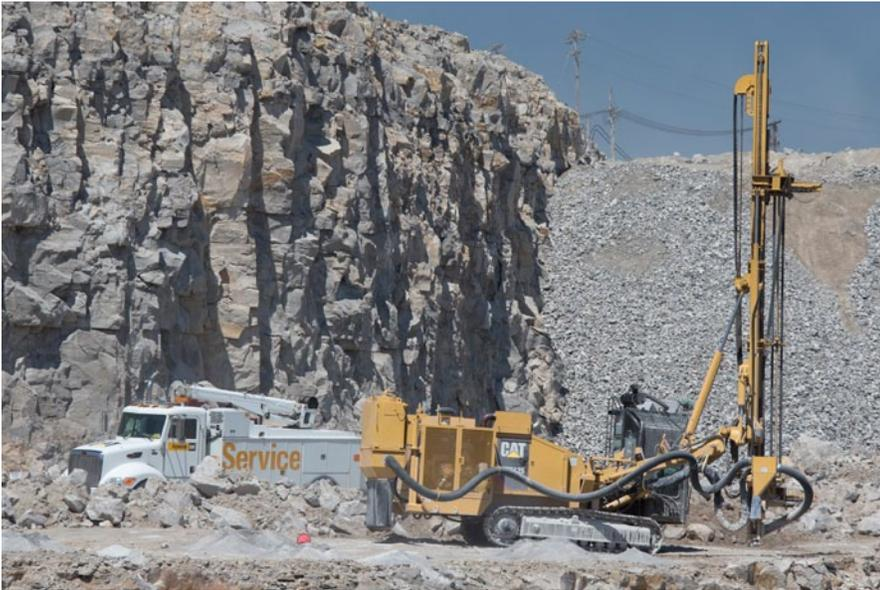
***Para simplificar los requisitos de mantenimiento, las Perforadoras de Cadenas Cat cuentan con diseños eléctricos e hidráulicos bien organizados. Esto ayuda a prolongar el ciclo de vida del equipo, a disminuir los costos de operación y a aumentar el valor de reventa.***
