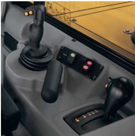
Control de palanca universal: posiciones, interruptores y botones
