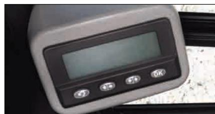
**Messenger.** Il Messenger è un sistema di controllo elettronico che monitorizza in tempo reale il funzionamento dei principali sistemi della macchina. Esso fornisce informazioni sulle prestazioni, sul consumo di combustibile, diagnosi e consente all'operatore di regolare alcuni parametri come modulazione attrezzature e sterzo.
