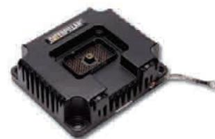
**Product Link.** A richiesta è disponibile un sistema satellitare che consente di ottenere alcune informazioni dalla macchina. Il Product Link consente di rilevare, tramite una rete satellitare, un computer ed un software dedicato, alcuni parametri di funzionamento, il numero di ore, la posizione della macchina ed i codici di errore. Secondo la versione, il Product Link, può essere collegato con altri sistemi di bordo e può fornire anche i consumi di combustibile.
