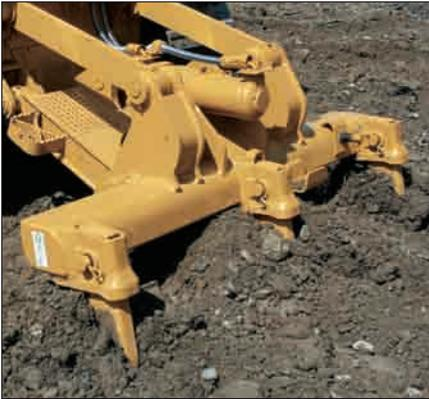
**Ripper a parallelogramma.** Il ripper parallelogramma multidentato consente di lavorare con uno, due o tre denti, secondo le condizioni. Sono disponibili denti dritti o curvi. Il telaio ad alta resistenza consente il montaggio di robusti supporti per il ripper, per affrontare lavori gravosi.
