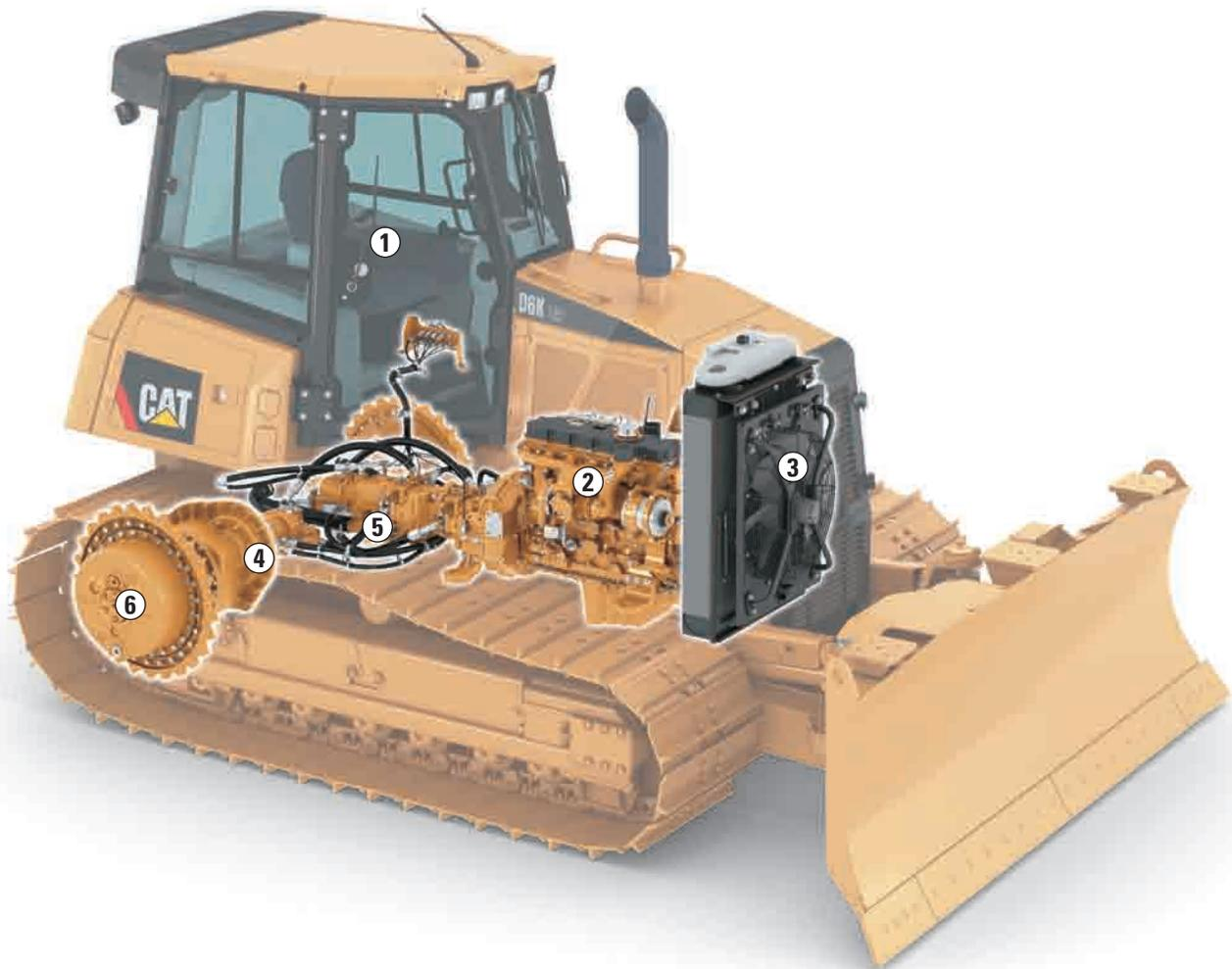
**1 Comandi velocità e direzione.** Un joystick elettroidraulico consente un facile azionamento, con un'unica mano, di velocità e direzione di marcia.
