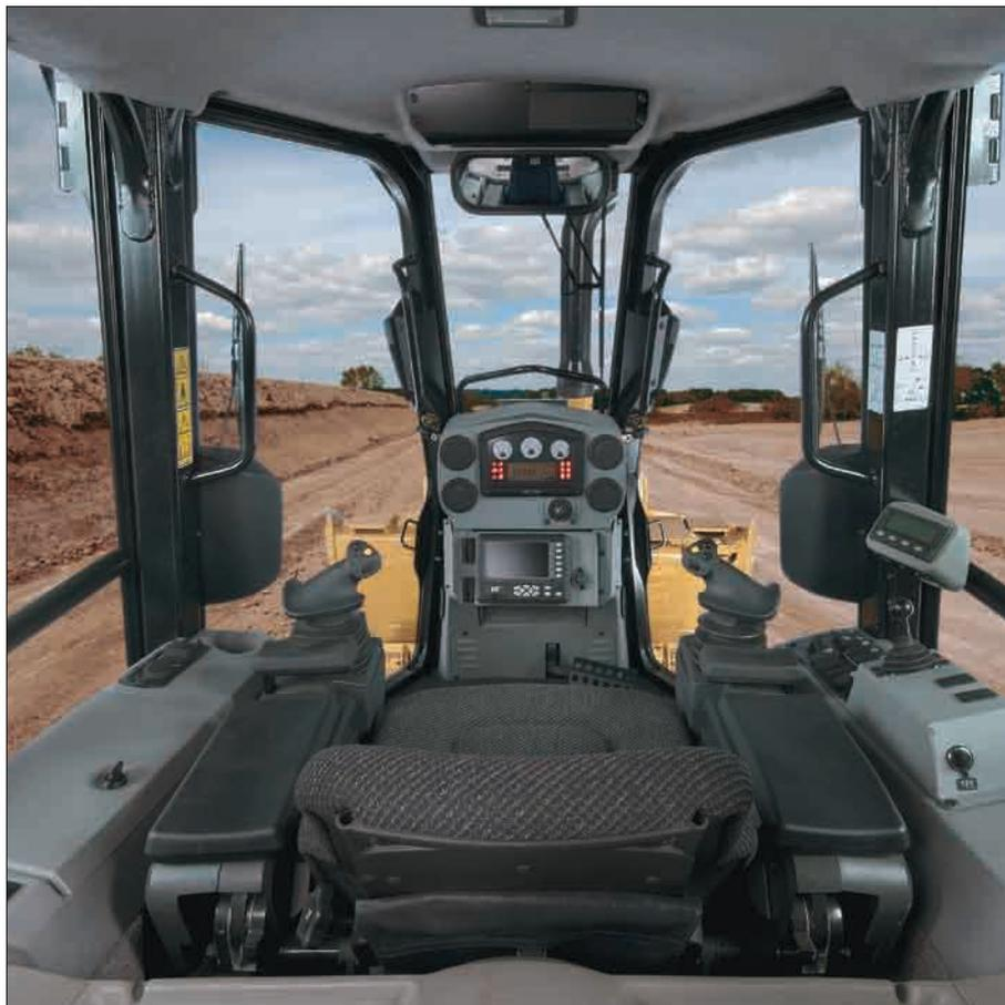
**Cabina.** La cabina offre ergonomia e semplicità, facilità d'uso e comfort. Il condizionatore standard, l'ampio spazio per le gambe e l'eccellente visibilità consentono all'operatore di concentrarsi meglio sul lavoro. Con una maggiore superficie vetrata, la cabina offre un'ampia visibilità sulla lama e sull'area di lavoro.
