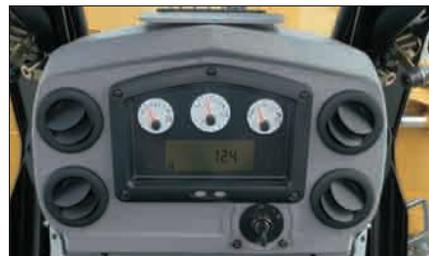
**Pannello strumenti.** Il compatto pannello strumenti (mostrato con il display Accugrade opzionale) fornisce all'operatore le informazioni vitali sul funzionamento della macchina. L'avanzato sistema elettronico di monitoraggio controlla le condizioni operative della macchina ed informa l'operatore su problemi insorgenti. Il sistema di monitoraggio Caterpillar comprende:
