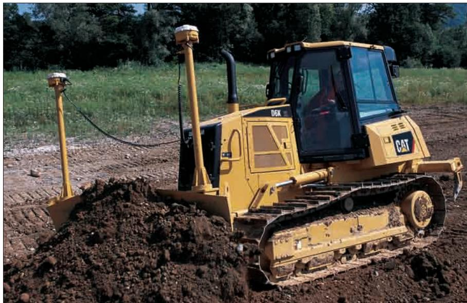
**AccuGrade Laser.** L'AccuGrade Laser è un sistema realizzato per mantenere piani con estrema precisione, utilizzando un trasmettitore ed un ricevitore laser.
