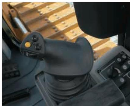
**Comandi attrezzature.** Il D6K può essere equipaggiato con il ripper e con il verricello. Per la massima flessibilità, il D6K può essere predisposto con il comando idraulico per il ripper, per il verricello o per entrambi.
