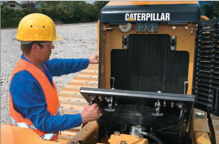
**Diagnose.** Die kompakte Instrumententafel mit updatefähiger Software, leicht ablesbaren Analog-/ Digitalanzeigen, dreistufigem Warnsystem und zahlreichen Warn-/ Kontrollleuchten informiert über Funktionsfehler und deren Ursachen.
