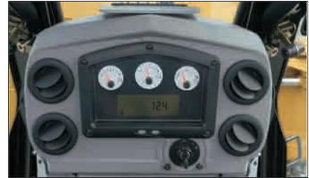
**Instrumententafel.** Die im direkten Sichtfeld des Fahrers platzierte Instrumententafel – im nebenstehenden Foto mit AccuGrade-Bedien- und Kontrolleinheit abgebildet – informiert über alle wichtigen Maschinenfunktionen:
