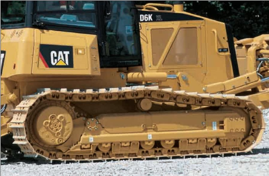
**Laufwerk SystemOne™.** Gegenüber allen bisherigen Laufwerken zeichnet sich das für nahezu jeden Einsatz ideal geeignete Cat Laufwerk SystemOne durch deutlich längere Standzeiten und erheblich niedrigere Betriebskosten aus. Die technischen Besonderheiten:
