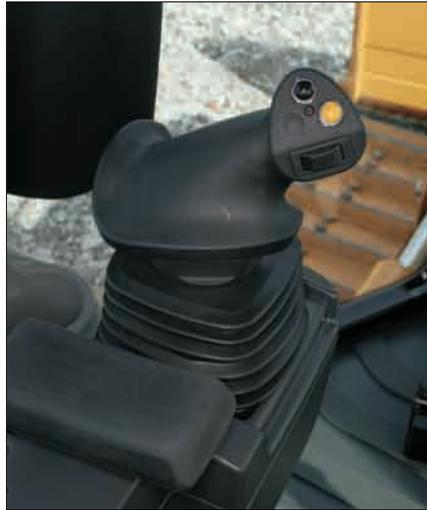
**Fahrtriebsteuerung.** Das Steuern aller Fahr- und Lenkfunktionen erfolgt über den linken Joystick. Im Knauf des Joysticks befinden sich ein Rändelrad zum Feinsteuern der Fahrgeschwindigkeit sowie eine Taste zum Speichern und Abrufen der individuell einstellbaren, gewünschten Vorwärts- und Rückwärts-Geschwindigkeiten.
