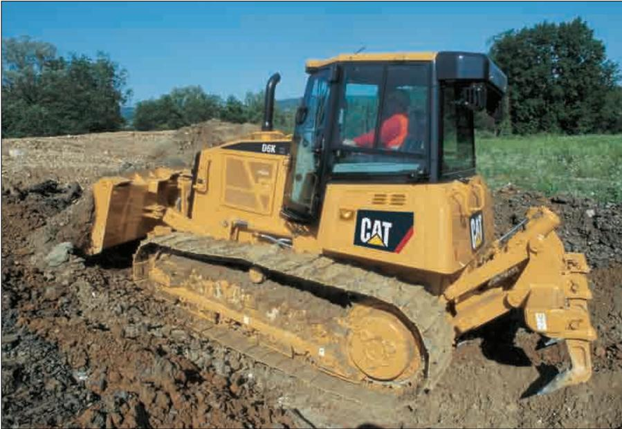
**Bedienung.** Zum hydrostatischen Fahrtrieb gehört eine automatische Drehzahlregelung, die bei jeder Lastsituation eine optimale Koordinierung von Dieselmotor, Fahrtrieb und Hydraulik bewirkt, sodass dem Fahrer das Manövrieren der Maschine und das Positionieren der Arbeitsausrüstung wesentlich erleichtert wird.
