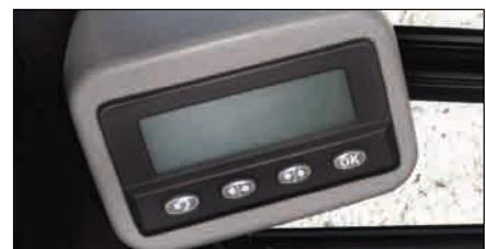
**Überwachungssystem.** Auf dem voll grafikfähigen LC-Display des Cat Messenger können wichtige Maschinenbetriebsdaten und Diagnoseinformationen angezeigt werden. Vier Wahl-tasten dienen zum Aufrufen der verschiedenen Daten und Diagnosebildschirme sowie zum Navigieren in den Display-Konfigurationsmenüs, die Änderungen der Einstellungen ermöglichen.
