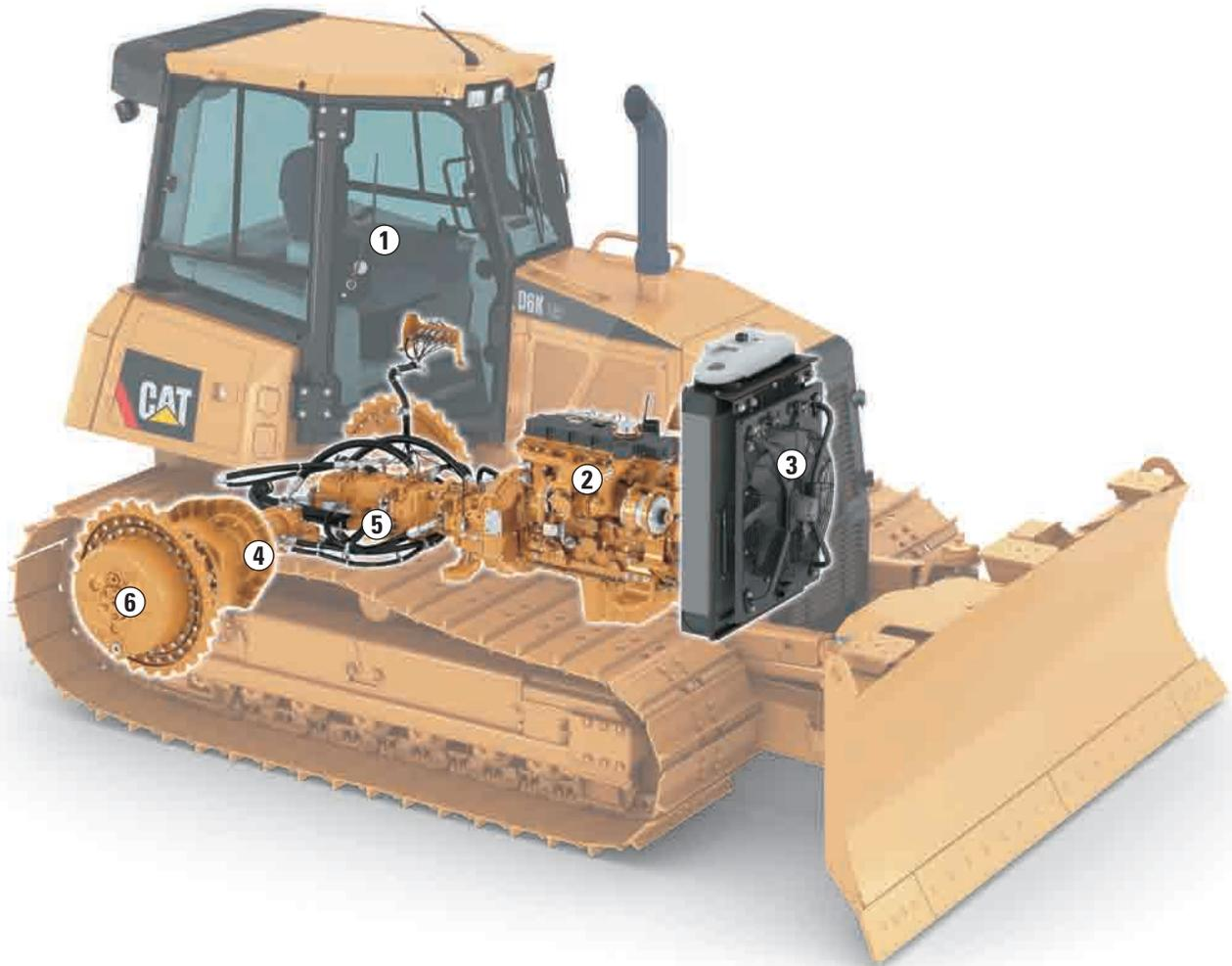
**1 Fahrtriebs-Joystick.** Der linke, sitzmontierte Joystick ermöglicht die elektrohydraulische Einhandbedienung des hydrostatischen Fahrtriebs.
