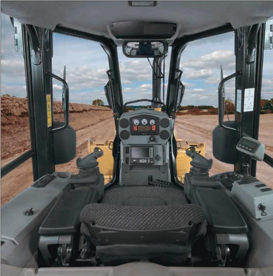
**Ergonomie/Komfort.** Bei der Neugestaltung des Kabinen-Innenraums wurde besonderer Wert auf ergonomische Bedienung gelegt, um den Fahrer weitgehend körperlich zu entlasten. Groß bemessene Fenster gewähren freie Sicht auf beide Schildecken und die gesamte Maschinenumgebung. Ein wichtiges Komfortelement ist die leistungsfähige Klimaanlage.
