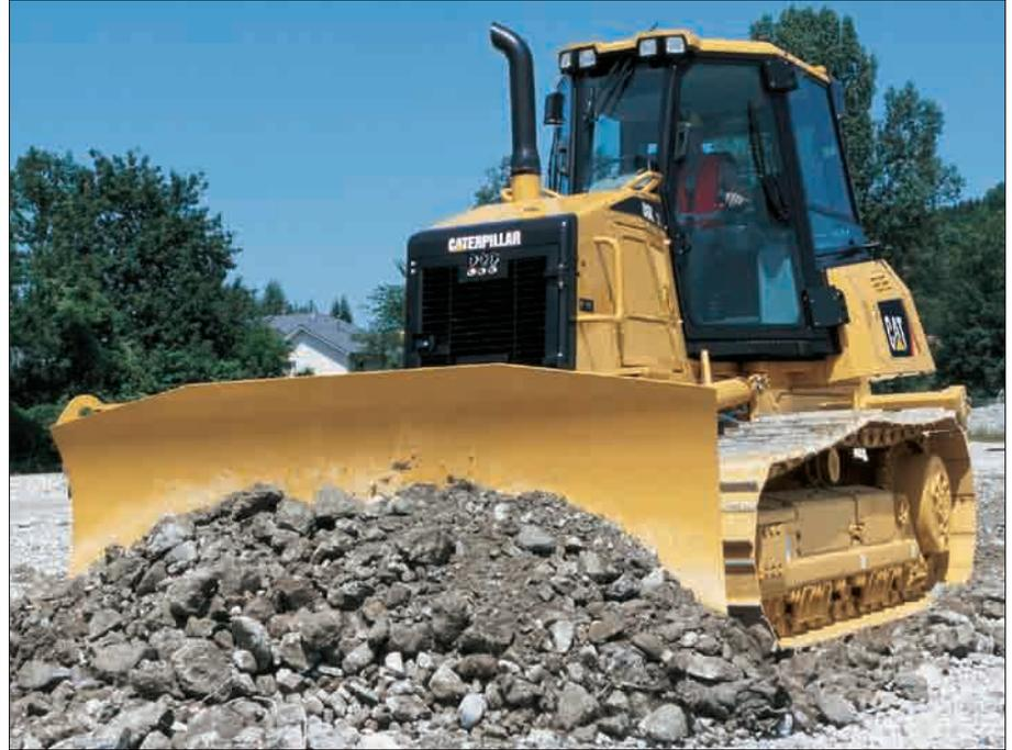
**VPAT-Klappschild.** Die Breite des für LGP-Maschinen erhältlichen Klappschildes verringert sich bei eingeklapptem Flügel auf weniger als 3 m, sodass der D6K auch auf öffentlichen Straßen mit angebautem Schild transportiert werden kann.
