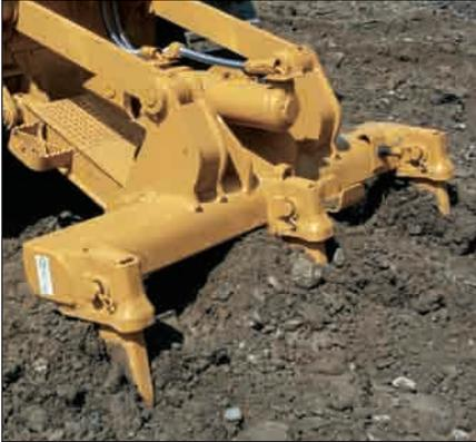
**Mehrzahn-Aufreißer.** Dieser Aufreißertyp mit Parallelogrammaufhängung bietet vielfache Anpassungsmöglichkeiten an das zu reißende Material durch den wahlweisen Einsatz von ein, zwei oder drei Zähnen. Darüber hinaus sind die Reißzähne in gerader und gebogener Ausführung lieferbar.
