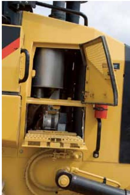
**Compartimentos do lado esquerdo.** A parte inferior da porta do compartimento pode ser usada como um degrau para acessar o abastecimento do tanque de derivação, o pré-purificador de ar (se equipado) e permitir a fácil limpeza da janela traseira.
