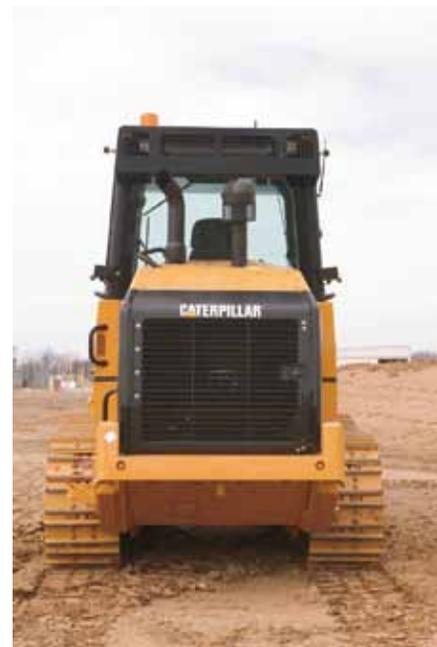
**Localização Traseira do Motor.** A localização traseira do motor permite excelente visibilidade de avanço, ao mesmo tempo em que funciona como um contrapeso. Ela também ajuda a reduzir o entupimento do radiador fornecendo um acesso fácil ao motor e a outros componentes principais para manutenção.
