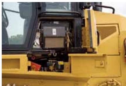
**Filtro de Ar da Cabine.** O filtro de ar da cabine, as tomadas de pressão agrupadas, a barra de travamento da inclinação da cabine, o cilindro opcional de inclinação da cabine, a caixa de ferramentas e os filtros de óleo hidráulico estão convenientemente localizados abaixo da janela do lado esquerdo da cabine.
