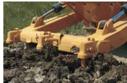
**Escarificador.** Um escarificador-escarificador está disponível para a 963D como um acessório. Ele é fixado com dois pinos pressionados em cada lado do chassi principal. Dois cilindros levantam e abaixam o escarificador. A viga do escarificador possui três encaixes para segurar o porta-pontas do escarificador. Os pinos de articulação não exigem lubrificação.
