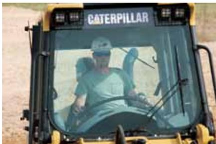
**Área de Visibilidade.** As janelas grandes usam vidros fumê para reduzir a claridade e fornecer uma excelente visão da caçamba, das esteiras e ao redor da cobertura do motor até a parte traseira.
