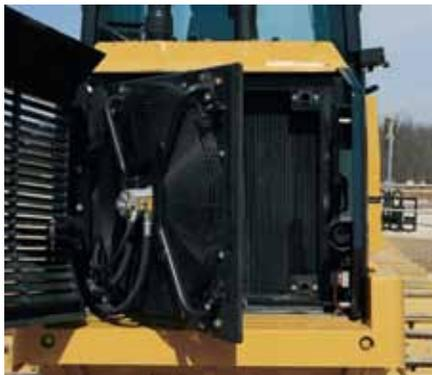
**Sistema de Arrefecimento.** O ventilador e a abertura articulada da grade abrem, fornecendo excelente acesso para limpeza e manutenção. A grade com trava reforçada diminui o acúmulo de detritos.
