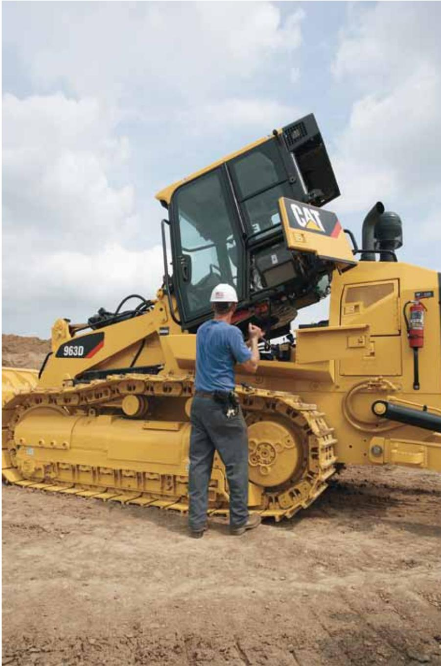
**Cabine Inclinável.** A 963D é equipada com uma cabine inclinável. Este novo recurso facilita a manutenção e os reparos. Ao inclinar a cabine, você pode acessar o trem de força e realizar uma manutenção completa do sistema hidráulico.
