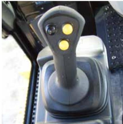
**Velocidades de Deslocamento.** As velocidades de deslocamento são infinitamente variáveis entre zero e a velocidade máxima. Dois modos de velocidade, “trabalho” e “deslocamento”, fornecem duas faixas diferentes de velocidade para associar da melhor forma a velocidade e o torque da máquina às condições de trabalho para obter máxima produtividade. A velocidade de deslocamento máxima é de 10 km/h (6,2 mph) quando o interruptor está configurado na posição de deslocamento.
