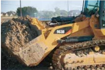
**Controles Eletro-hidráulicos do Implemento.** Os controles eletro-hidráulicos do implemento na 963D fornecem ao operador um controle responsivo, suave e preciso da caçamba e dos braços de levantamento. Eles também permitem que o operador defina parâmetros pessoais através do Messenger, como reações do implemento.
