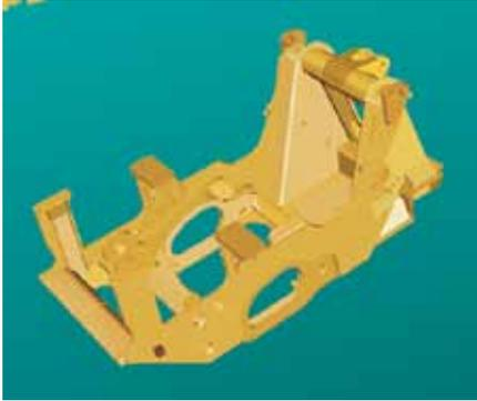
**Chassi Principal e Torre de Sustentação.** O Chassi Principal e Torre de Sustentação da 963D são trilhos maciços com seções transversais reforçadas, com peças fundidas e forjadas incorporadas em pontos de alta tensão, para distribuir essas tensões sobre áreas mais amplas para fornecer uma vida útil da estrutura mais longa.
