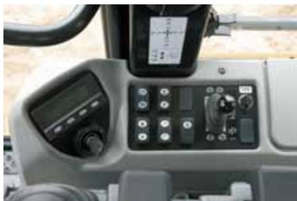
**Sistema de Partida.** O Interruptor do Seletor de Velocidade Eletrônico (A), uma chave seletora localizada no console direito, define a rpm do motor. O controlador do motor ADEM A4 sempre dará a partida no motor em marcha lenta baixa. É possível ver a rpm do motor no monitor digital de um grupo de instrumentos ou no menu de desempenho no Messenger.
