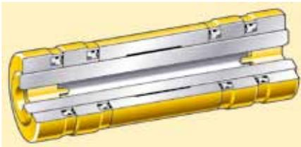
**Juntas de Cartucho.** Juntas de cartucho vedadas de fábrica são soldadas para controlar a folga axial. Elas oferecem maior integridade de vedação por meio de um novo sistema de vedação inovador e não dependem da interface da articulação para permanecerem vedadas. Assim como com todos os produtos do novo material rodante Cat, elas são enchidas com óleos especiais.
