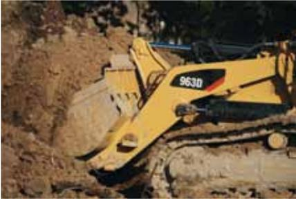
**Caçamba de Propósito Geral.** A caçamba de Propósito Geral (PG) é projetada para oferecer excelente capacidade de carga e vida útil prolongada em uma ampla variedade de aplicações, como escavação difícil em bancada, corte e carregamento em pilhas. O aço de liga baixa e alta resistência ajuda a caçamba a resistir a amassos e abrasão. A extremidade traseira da caçamba é projetada para oferecer mais eficiência em operações de arrasto para trás.
