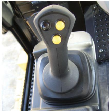
**Vitesses de translation.** Les vitesses de translation sont infiniment variables entre zéro et la vitesse maximale. Deux modes de vitesse, « travail » et « translation », fournissent deux plages de vitesse différentes pour mieux adapter la vitesse de la machine et le couple aux conditions du chantier en vue d'une productivité optimale. La vitesse de translation maximale est de 10 km/h lorsque l'interrupteur est en position de translation.
