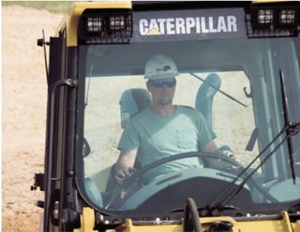
**Champ visuel.** Les larges vitres sont en verre teinté pour réduire la luminosité et offrir une excellente visibilité sur le godet, les chaînes et le pourtour du capotage moteur à l'arrière.
