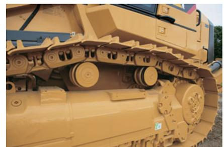
**Galets supérieurs.** La 963D compte sept galets inférieurs qui répartissent le poids de la machine sur une zone étendue, et deux galets supérieurs de chaque côté du châssis principal de la machine.
