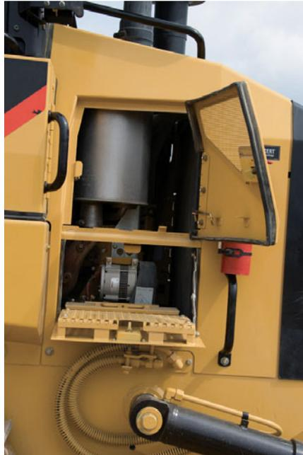
**Compartiments de gauche.** La partie inférieure de la porte du compartiment peut servir de marchepied pour accéder au dispositif de remplissage du réservoir, au préfiltre à air (selon équipement), et facilite le nettoyage de la vitre arrière.
