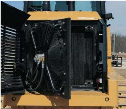
**Circuit de refroidissement.** Le ventilateur et la grille s'ouvrent en pivotant, offrant un accès facile pour les opérations de nettoyage et d'entretien. La grille verrouillable extra-robuste réduit l'accumulation de débris.
