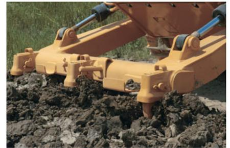
**Ripper-scarificateur.** Un ripper-scarificateur radial est disponible en option pour la 963D. Il est monté avec deux axes insérés de chaque côté du châssis principal. Deux vérins relèvent et abaissent le ripper. La traverse de ripper comporte trois poches pour maintenir les porte-dents. Les axes de timonerie ne nécessitent aucun graissage.
