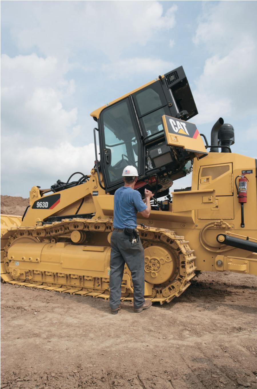
**Cabine inclinable.** La 963D est équipée d'une cabine inclinable. Cette nouvelle fonctionnalité facilite les opérations d'entretien et de réparation. En inclinant la cabine, vous pouvez accéder à la chaîne cinématique et effectuer l'entretien complet du circuit hydraulique.
