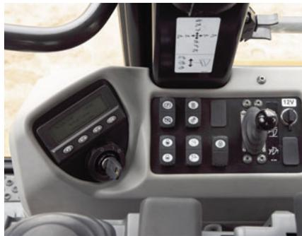
**Circuit de démarrage.** Le sélecteur de vitesse électronique « Electronic Speed Selector Switch » (A), interrupteur à bascule situé sur la console de droite, définit le régime moteur. La commande moteur ADEM A4 démarre toujours le moteur au ralenti bas. Le régime moteur est indiqué par l'affichage numérique du bloc d'instruments, dans le groupe d'instruments ou dans le menu Performances de Messenger.
