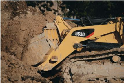
**Godet normal.** Le godet standard est conçu pour optimiser le chargement et le cycle de vie dans un large éventail d'applications, comme les travaux d'excavation difficiles, le décapage et le chargement par mise en tas. L'acier faiblement allié à haute résistance protège le godet contre les entailles et l'abrasion. Le bord arrière du godet est conçu pour une meilleure efficacité lors du raclage en marche arrière.
