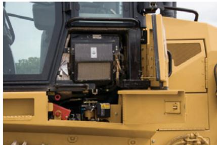
**Filtre à air de cabine.** Le filtre à air de cabine, les prises de pression groupées, la barre de verrouillage de la cabine inclinable, le vérin d'inclinaison de cabine en option, la boîte à outils et les filtres à huile hydraulique sont idéalement placés sous la vitre gauche de la cabine.
