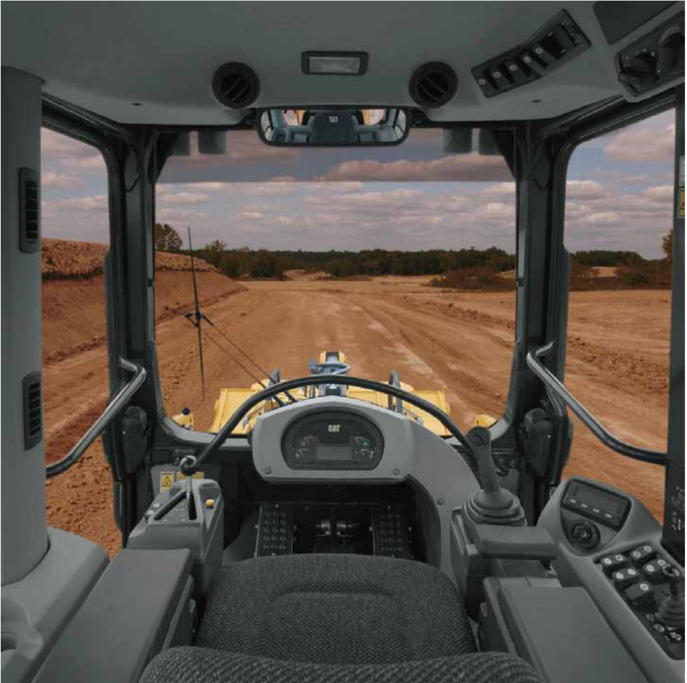
**Aquecimento e Ar Condicionado.** O ar condicionado é padrão na 953D. Tanto o ar condicionado como o aquecedor fornecem ar filtrado, pressurizado, de temperatura controlada ao operador e janelas através de 10 saídas com venezianas.
