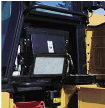
**Filtro de Ar da Cabine.** O filtro de ar da cabine, as tomadas de pressão agrupadas, a barra de travamento da inclinação da cabine, o cilindro de inclinação opcional e a caixa de ferramentas estão convenientemente localizados abaixo da janela do lado esquerdo da cabine.
