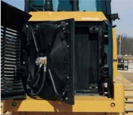
**Sistema de Arrefecimento.** O ventilador e a abertura articulada da grade abrem, fornecendo excelente acesso para limpeza e manutenção. A grade com trava para serviços pesados diminui o acúmulo de detritos.
