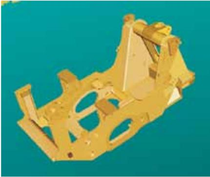
**Chassi Principal e Torre de Sustentação.** O Chassi Principal e a Torre de Sustentação da 953D são trilhos maciços únicos com seções transversais reforçadas, com peças fundidas e forjadas incorporadas em pontos de alta tensão, para distribuir essas tensões sobre áreas mais amplas para fornecer uma vida útil da estrutura mais longa.
