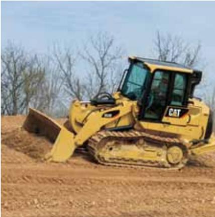
**Controles Eletro-hidráulicos do Implemento.** Os controles eletro-hidráulicos do implemento na 953D fornecem ao operador um controle responsivo, suave e preciso da caçamba e dos braços de levantamento. Eles também permitem que o operador defina parâmetros pessoais através do Messenger (opcional), como reações do implemento.
