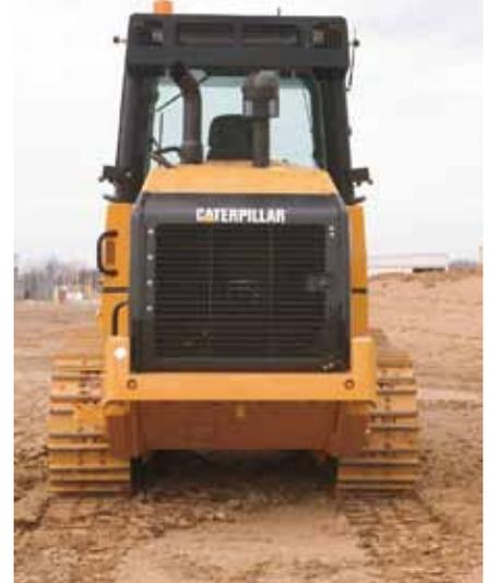
**Localização Traseira do Motor.** A localização traseira do motor permite excelente visibilidade de avanço, ao mesmo tempo em que funciona como um contrapeso. Ela também ajuda a reduzir o entupimento do radiador fornecendo um acesso fácil ao motor e a outros componentes principais para manutenção.
