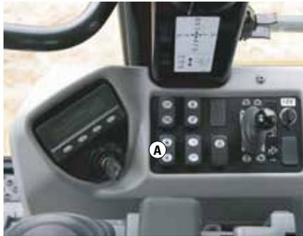
**Sistema de Partida.** O Interruptor do Seletor de Velocidade Eletrônico (A), uma chave seletora localizada no console direito, define a rpm do motor. O controlador do motor ADEM A4 sempre dará a partida no motor em marcha lenta baixa. É possível ver a rpm do motor no monitor digital de um grupo de instrumentos no grupo de medidores ou no menu de desempenho no Messenger.
