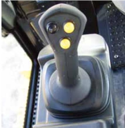
**Velocidades de Deslocamento.** As velocidades de deslocamento são infinitamente variáveis entre zero e a velocidade máxima. Dois modos de velocidade, “trabalho” e “deslocamento”, fornecem duas faixas diferentes de velocidade para associar da melhor forma a velocidade e o torque da máquina às condições de trabalho para obter máxima produtividade. A velocidade de deslocamento máxima é de 10 km/h (6,2 mph) quando o interruptor está configurado na posição de deslocamento.
