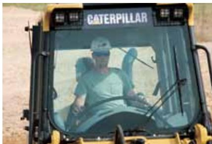
**Área de Visibilidade.** As janelas grandes usam vidros fumê para reduzir a claridade e fornecer uma excelente visão da caçamba, das esteiras e ao redor da cobertura do motor até a parte traseira. Janelas laterais deslizam de cima para baixo para permitir que o operador deixe ar fresco entrar na cabine e possa se comunicar.
