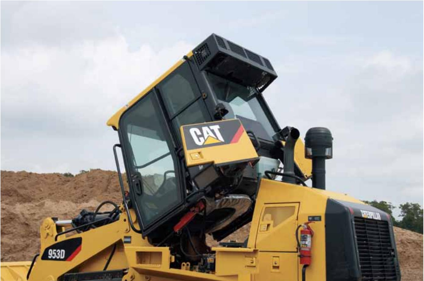
**Cabine Inclinável.** A 953D é equipada com uma cabine inclinável. Este recurso facilita a manutenção e os reparos. Ao inclinar a cabine, você pode acessar o trem de força e realizar uma manutenção completa do sistema hidráulico.
