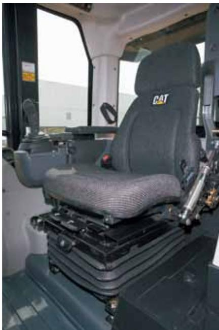
**Assento com Suspensão a Ar da Caterpillar.** O assento com suspensão a ar da Caterpillar, com isolamento lado a lado, é ergonomicamente projetado e totalmente ajustável para máximo conforto e controle do operador. O cinto de segurança retrátil tem 75 mm (3 pol) de largura para contenção positiva e confortável.
