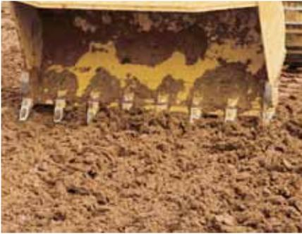
**Caçamba de Propósito Geral.** A caçamba de Propósito Geral (PG) é projetada para oferecer excelente capacidade de carga e vida útil prolongada em uma ampla variedade de aplicações, como escavação difícil em bancada, corte e carregamento em pilhas. O aço de liga baixa e alta resistência ajuda a caçamba a resistir a amassos e abrasão.
