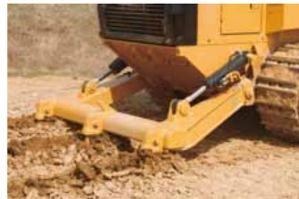
**Escarificador.** Um escarificador está disponível para a 953D como um acessório. Ele é fixado com dois pinos pressionados em cada lado do chassi principal. Dois cilindros levantam e abaixam o escarificador. A viga do escarificador possui três encaixes para segurar o porta-pontas do escarificador. Os seis pinos na articulação não exigem lubrificação.
