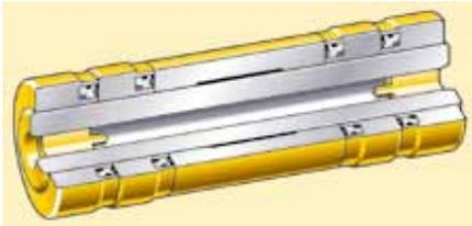
**Juntas de Cartucho.** Juntas de cartucho vedadas de fábrica são soldadas para controlar a folga axial. Elas oferecem maior integridade de vedação por meio de um novo sistema de vedação inovador e não dependem da interface da articulação para permanecerem vedadas. Assim como com todos os produtos do novo material rodante Cat, elas são enchidas com óleos especiais.
