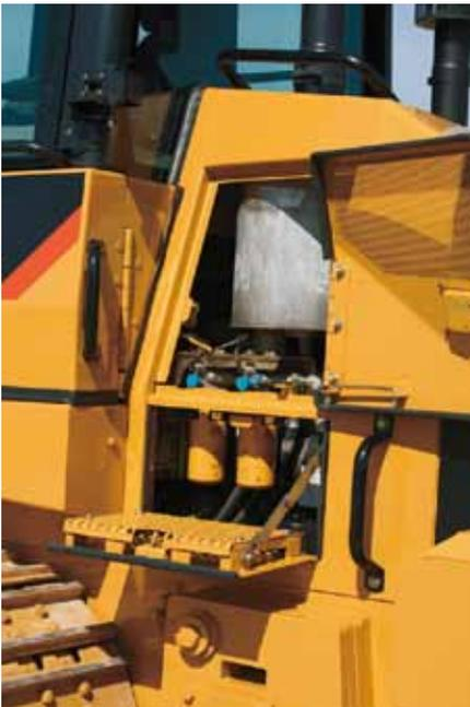
**Compartimentos do lado esquerdo.** O compartimento do lado esquerdo do motor inclui dois filtros de óleo hidráulico rosqueados que fornecem filtragem do sistema hidrostático.
