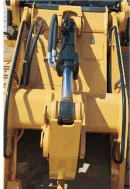
**Cilindro com sensor de posição.** Os cilindros com sensor de posição permitem:
