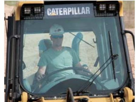
**视野。**采用茶色玻璃制成的大车窗减少了反光，且具有良好的视野，对铲斗、履带和发动机护罩至后部的周边范围可一目了然。
