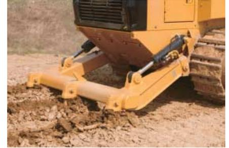
**裂土器-松土器。**在 953D 上，径向裂土器-松土器作为附件。它用两个销安装在主机架的每一侧。抬起两个油缸和降下裂土器。裂土器梁有三个槽容纳裂土柄。连杆上的 6 个销不需要润滑。
