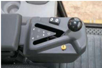
**行驶速度。**行驶速度可在零和最高车速之间无限变化。两种车速模式“行驶模式”和“工作模式”，提供两种不同的车速范围，使机器车速和扭矩实现最佳匹配，以获得最高的生产率。当开关位于行驶位置时，最高行驶速度为 10 kph (6.2 mph)。
