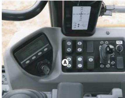
**起动系统。**电子速度选择器开关 (A)，一种“摇臂”开关，位于右侧控制台上，可用来设定发动机转速。ADEM A4 发动机控制器将始终在低怠速下起动发动机。在仪表盘组仪表盘的数显窗口上可以看到发动机转速，也可以从通讯器的性能菜单上看到这个转速值。
