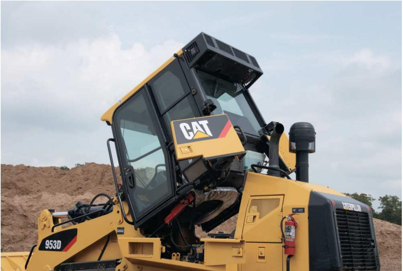
**可倾斜驾驶室。**953D 配备一个可倾斜驾驶室。该特性使得维护保养和维修更加简便。通过倾斜驾驶室，可以接近传动系并对液压系统进行全面的维修。
