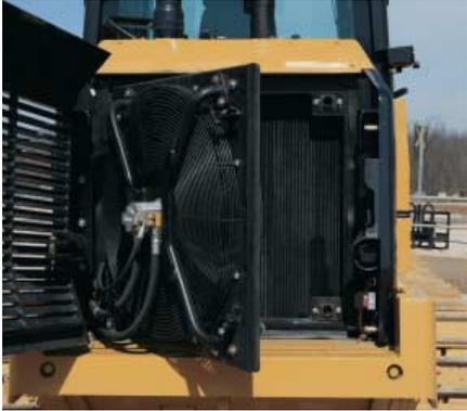
**冷却系统。**风扇和隔栅可回转打开，非常便于清洁和维护保养。重载带锁格栅不易堆积碎屑。
