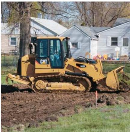
**可变排量泵和驱动器马达。**可变排量泵和驱动器马达由 EHC 电子控制，效率高，行驶精确。每条履带都由一个单独的液压回路独立驱动，该回路由一个通过卡特彼勒 XT-6™ 液压软管连接的一个泵和一个与柱塞马达相连的接头构成。
