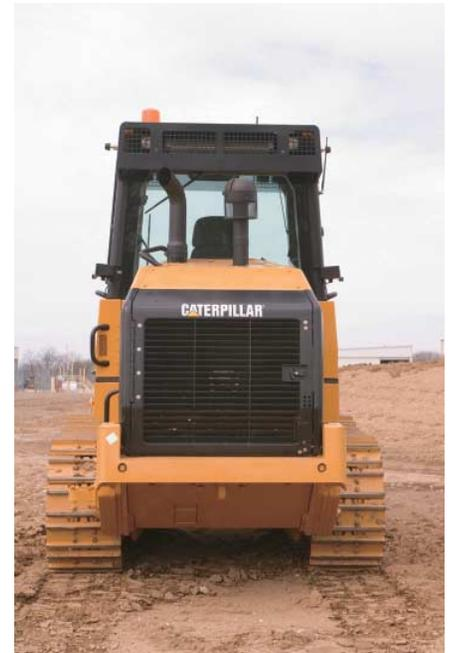
**发动机后部位置。**发动机后部位置能够获得极好的前向视野，同时可作为工作配重使用。它还有助于减少散热器堵塞，能够方便检修发动机和其它主要部件。
