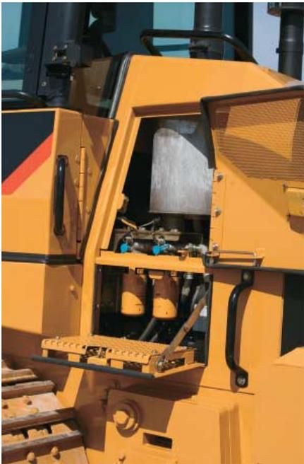
**左侧发动机室。**左侧发动机室包括两个旋装式液压油滤清器，可对静液压系统进行过滤。
