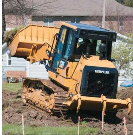
**摇摆式底盘系统。**953D 上的底盘系统有一个“摇摆式履带支重轮架”，它可减少地面振动对机器的影响，增强机器的稳定性、操作员乘坐舒适性和操作的平顺性。当机器在不平整地形上行驶时，摇摆式履带支重轮架让履带与地面的接触面积更大，这样操作员会觉得机器的稳定性更好，操作速度也会相应提高，从而提高了机器的生产率，减少了操作员的疲劳度。
