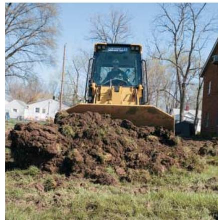
**操控性。**静液压传动系为每个履带提供独立的电源和控制，可对每个履带执行快速加速、无限变速、自动、现场和更改方向的操作。操作员只要踩下任意一个转向踏板即可指令平顺的“动力转向”操作，或者甚至使履带原地打转。卡特彼勒静液压系统能够进行自我管理，操作
