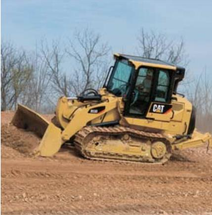
**电子液压机具控制装置。**953D 上的电子液压机具控制装置能够让操作员迅速响应，快速精确地控制铲斗和提升臂。它们还允许操作员通过选装的通讯器来设置个人参数，如机具反应。
