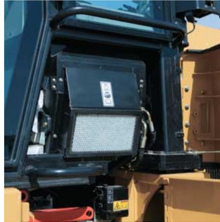
**驾驶室空气滤清器。**驾驶室空气滤清器、聚集在一起的压力塞、驾驶室倾斜锁杆、选装的倾斜油缸和工具箱都方便地位于驾驶室左侧车窗的下面。
