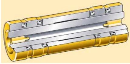
**卡盘接头。**焊接原厂密封卡盘接头来控制端隙。通过创新的密封系统，提高密封完整性，并不依赖连杆内表面保持密封。由于采用了全新的卡特彼勒底盘系统产品，它们加注了专用油。
