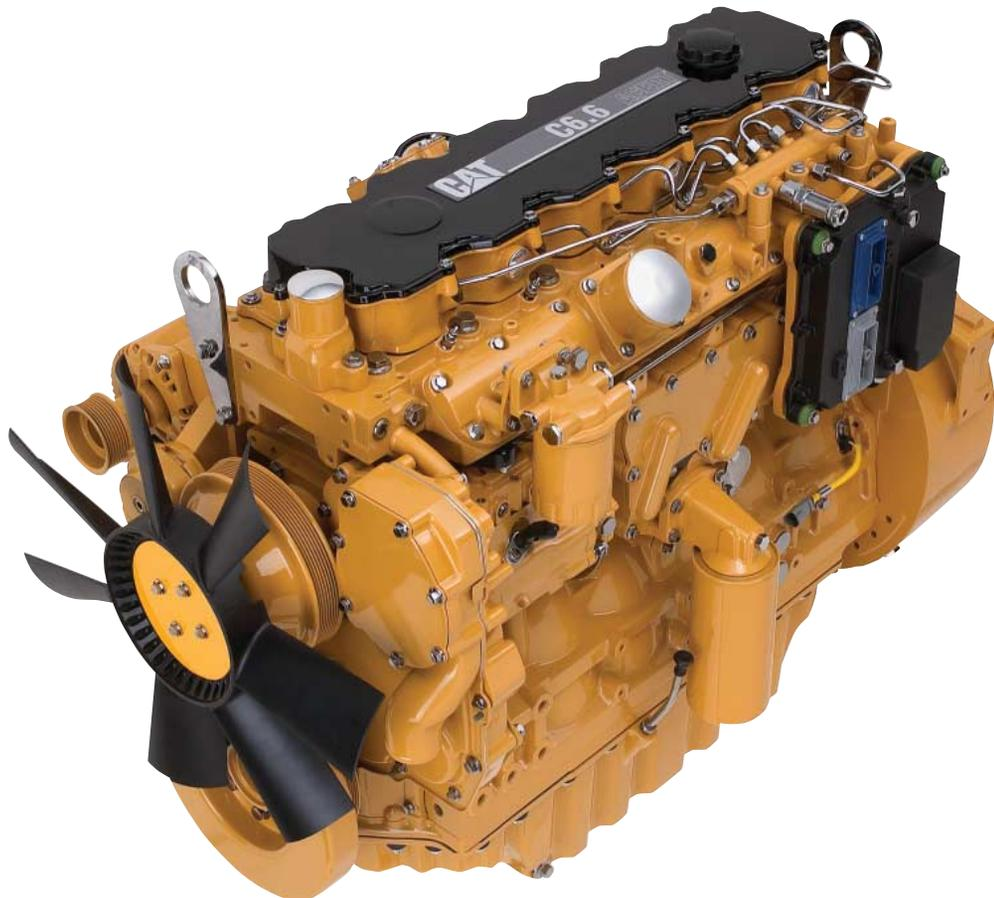
**Cat C6.6 ACERT™。** Cat® C6.6 是 6 缸、直列式发动机，其排量为 6.6 升 (403 in<sup>3</sup>)，它使用 Caterpillar® 共轨燃油系统进行燃油传送。它采用 ACERT™ 技术和一系列的卡特彼勒工程创新设计，实现了先进的电子控制，精确的燃油传送，以及精细的空气管理，保证出色的发动机性能，并达到降低排放的要求。
