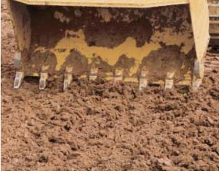
**普通铲斗。**通用 (GP) 铲斗在诸如硬实堤岸挖掘、剥离和堆料装载之类的应用中具有出色的装载能力和很长的寿命。高强度、低合金钢使铲斗可以抵抗凹痕和磨损。
