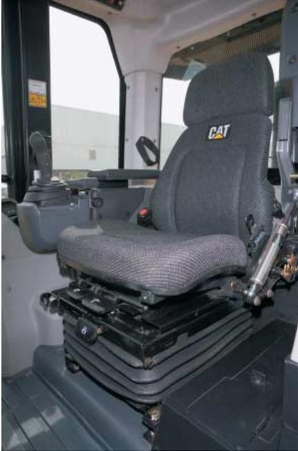
**卡特彼勒空气悬挂座椅。**带侧向隔振块的 Caterpillar 空气悬挂座椅采用人机工程设计，完全可调，具有最大程度的操作员舒适性和可控性。可伸缩座椅安全带宽度为 75 mm (3 in)，提供安全、舒适的束缚。
