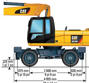
Train de roulement avec 1 jeu de stabilisateurs et une lame
