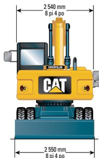
\*\* Dégagement maximal au niveau des pneus, stabilisateur complètement abaissé
