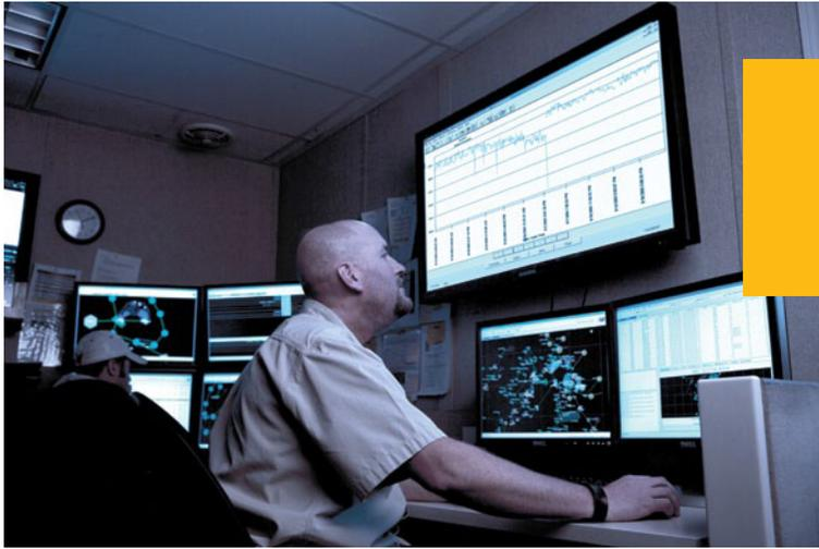
Cat MineStar 系统是行业内最全面的系统，它集成了矿场作业技术与移动设备管理技术，可以按作业需求进行配置。其功能套件包括 Fleet（车队）、Terrain（地形）、Detect（检测）、Health（运行状况）及 Command（命令），当中包含的一系列技术使您能够轻松应对一切事务：从车队分配到状态监控，再到远程与自动控制。993K 可以充分利用其中的许多先进技术，有些已成为标准的出厂配置。
