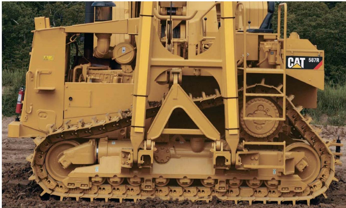
**Бортовые передачи.** Бортовые передачи и сопряженные с ними компоненты силовой передачи расположены высоко над грунтом, что защищает их от ударных нагрузок и от нагрузок, исходящих от рабочего оборудования трубоукладчика. Это увеличивает срок службы компонентов силовой передачи.
