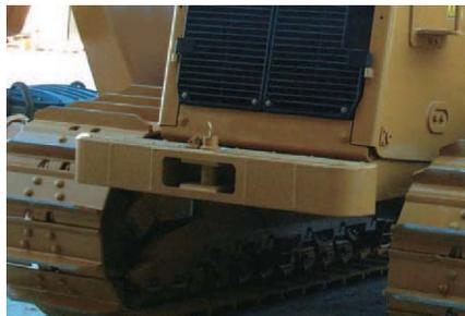
**Передний бампер.** Передний бампер крепится к балкам рамы, он обеспечивает защиту и является компонентом тягово-сцепного устройства. Кронштейны рамы трубоукладчика также выполнены заодно с рамой.
