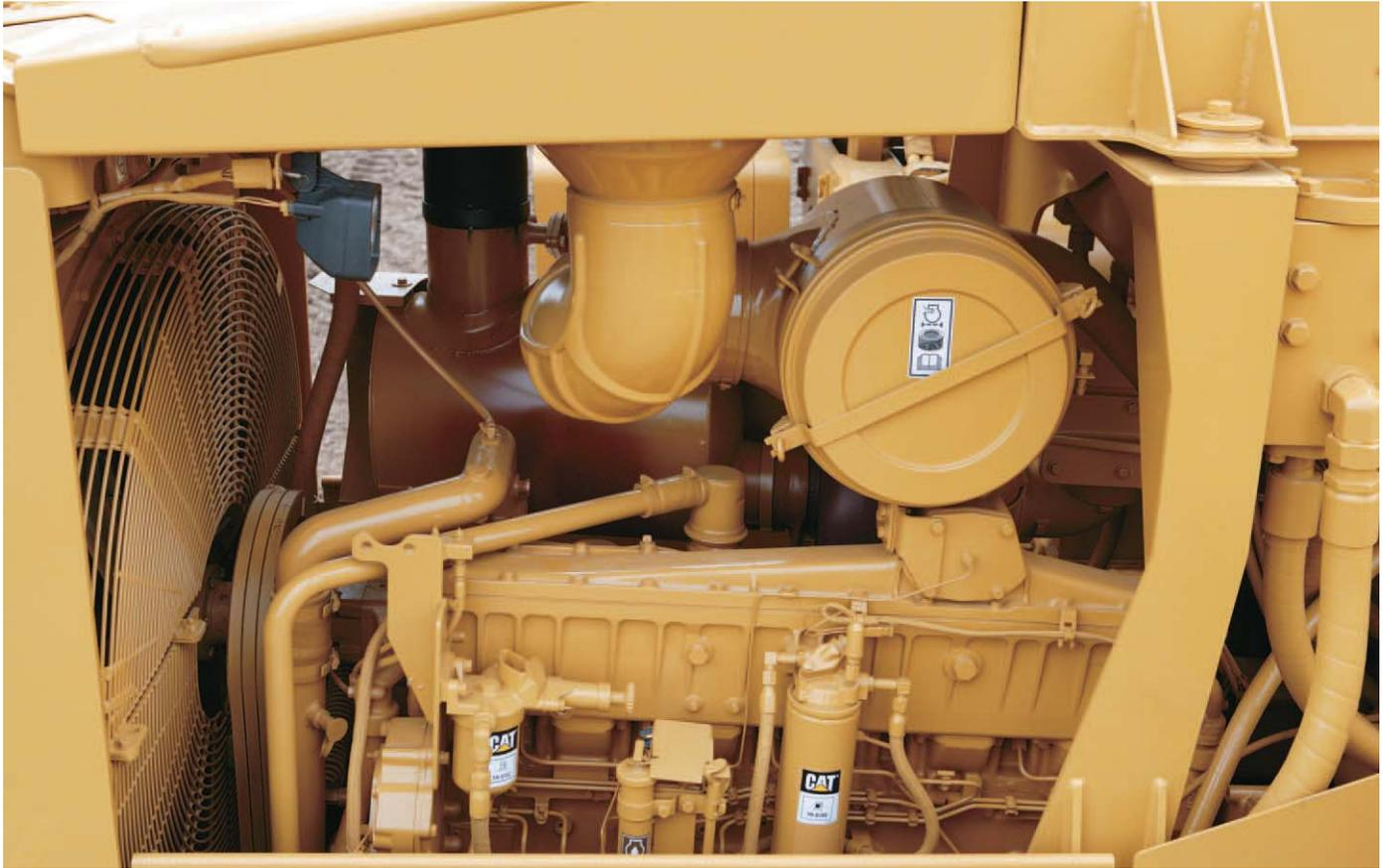
**Двигатель Cat 3406C** развивает номинальную полезную мощность 262 кВт (351 л. с.) при 1900 об/мин с увеличением крутящего момента на 55%. Благодаря большому рабочему объему и высокой скорости нарастания крутящего момента двигатель развивает мощность, которая позволяет трубоукладчику 587R выполнять самые сложные работы. Двигатель с большим рабочим объемом способен непрерывно работать в течение длительного времени.
