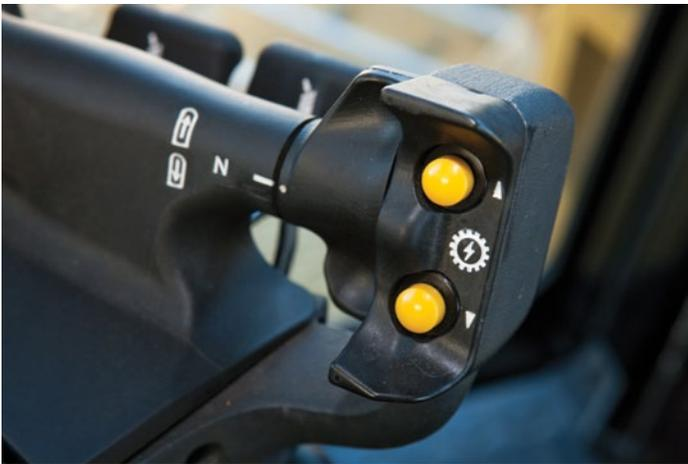
Los controles con la punta de los dedos (FTC) requieren de menos esfuerzo y son más cómodos para períodos de operación prolongados. Los controles de una sola mano en el posabrazos izquierdo coordinan la dirección mediante el uso de paletas (derecha e izquierda) accionadas por los dedos ubicadas adelante de la empuñadura. El D11T/D11T CD utiliza una dirección electrohidráulica de embrague-freno.
