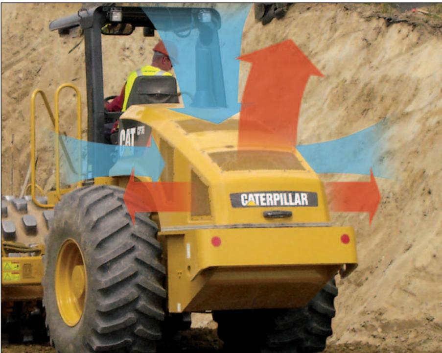
**Flujo de aire optimizado** que succiona el aire fresco de la parte media del capó y descarga el aire caliente por la parte trasera.
