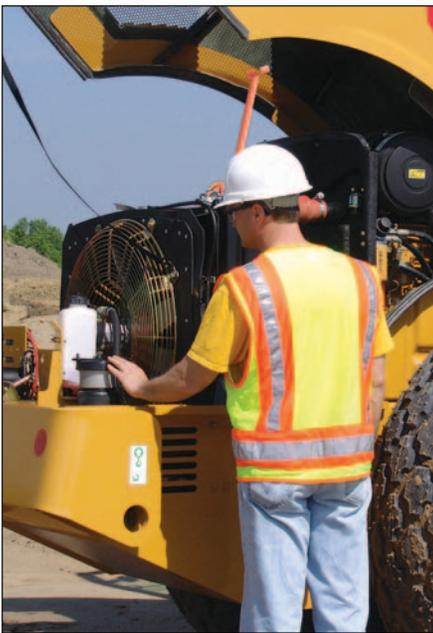
*El capó de fibra de vidrio de una sola pieza se inclina hacia adelante para proporcionar un acceso excepcional al motor y al sistema de enfriamiento. Los puntos de servicio proporcionan acceso a nivel del suelo y están agrupados a un lado de la máquina.*
