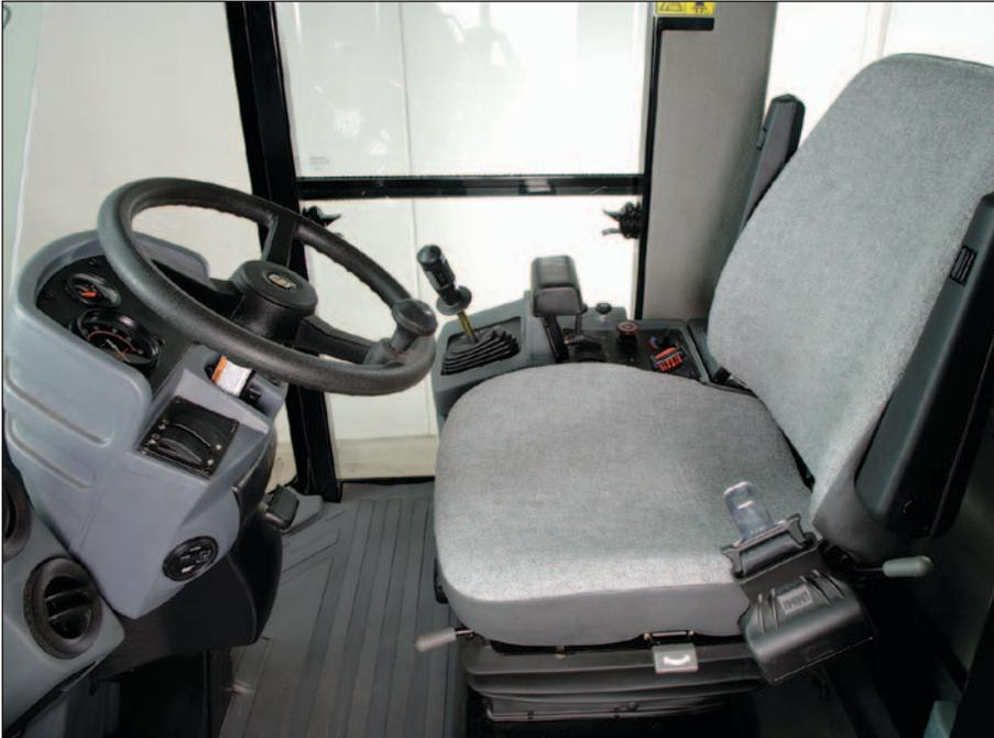
**Consola de dirección y medidores de instrumentos** infinitamente ajustables en la gama de inclinación a la posición deseada por el operador. La consola completa se inclina para facilitar la entrada y la salida del operador.
