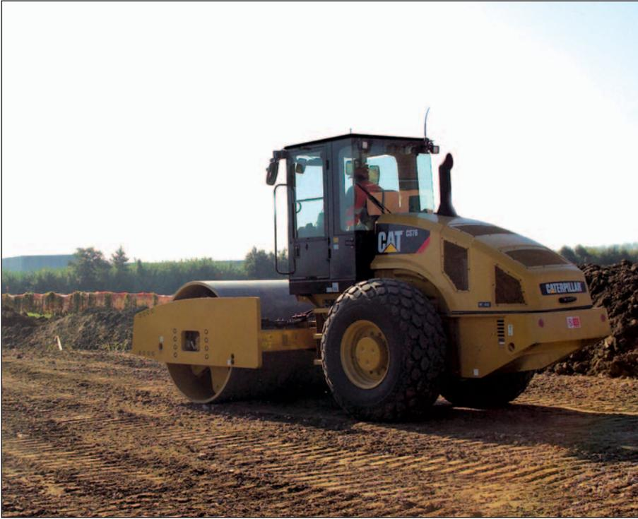
**Sistema de bombas dobles de propulsión**, con bombas dedicadas que impulsan independientemente la rueda trasera de alto par motor y servicio pesado y los motores del tambor. Si ocurre una pérdida de tracción en alguno de los motores, siempre se envía flujo hidráulico hacia el motor que no patina, permitiendo que la fuerza de tracción sea continua.
