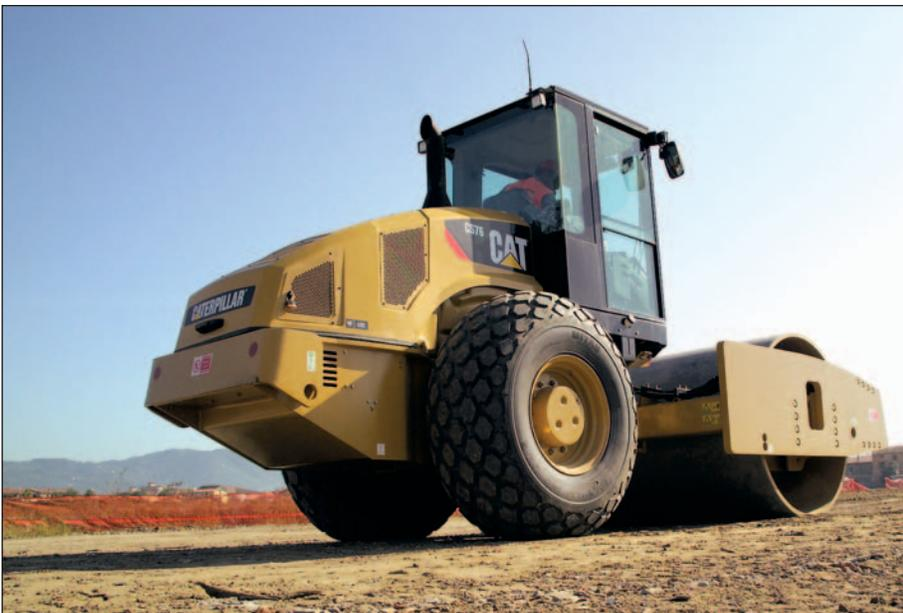
**Excepcional visibilidad hacia atrás** que proporciona línea de vista a los bordes de los neumáticos y a la parte trasera de la máquina. El operador puede ver obstáculos de 1 metro (3 pies 3 pulg) de alto, ubicados a 1 metro (3 pies 3 pulg) de la parte trasera de la máquina. Se ha disminuido el ancho de los guardabarros, al igual que el del parachoques trasero. La excelente visibilidad aumenta la productividad cuando se trabaja cerca de obstrucciones o se maniobra en el sitio de trabajo.
