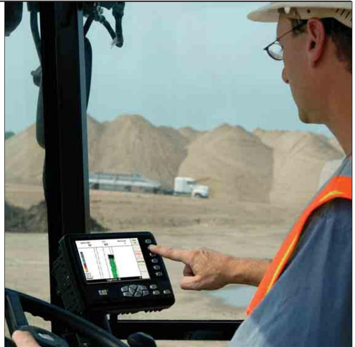
**Operadores más productivos.** El sistema informa a los operadores en tiempo real sobre el estado del trabajo, ayudándoles a determinar si el suelo ha alcanzado la densidad de compactación deseada. Esto elimina las aproximaciones a ojo e indica al operador cuándo puede desplazarse a otra zona de trabajo, reduciendo al mínimo el número de pasadas.
