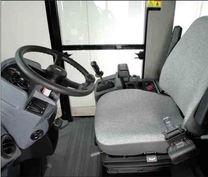
**Instrumentation.** Console de direction avec instrumentation réglable en continu, permettant d'obtenir la position la plus confortable pour le conducteur. La console est inclinable pour faciliter l'accès à la cabine.
