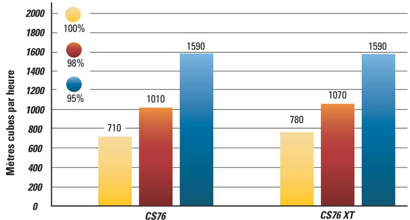
% de compactage du Proctor standard sur base de calcaire concassé de 300 mm
