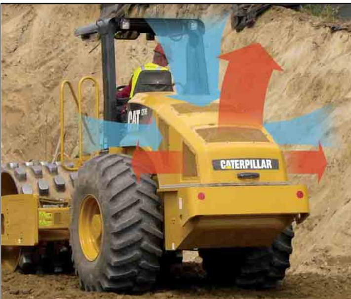
**Débit d'air optimisé.** Aspire l'air frais au milieu du capot et évacue l'air chaud vers l'arrière.
