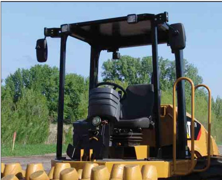
**Équipement de série.** Quatre projecteurs (deux vers l'avant et deux vers l'arrière), des mains courantes et des repose-pieds inclinés, une protection antivandalisme verrouillable et un rétroviseur sont montés de série.
