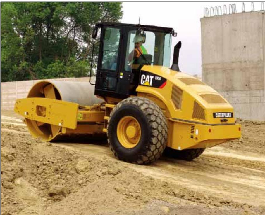
**As bombas dedicadas do sistema de bombas** de propulsão duplas acionam a roda traseira de torque alto reforçado e os motores do tambor independentemente. Se houver perda de tração em algum dos motores, haverá sempre o fluxo hidráulico para o motor que não esteja girando, permitindo o esforço de tração contínuo.
