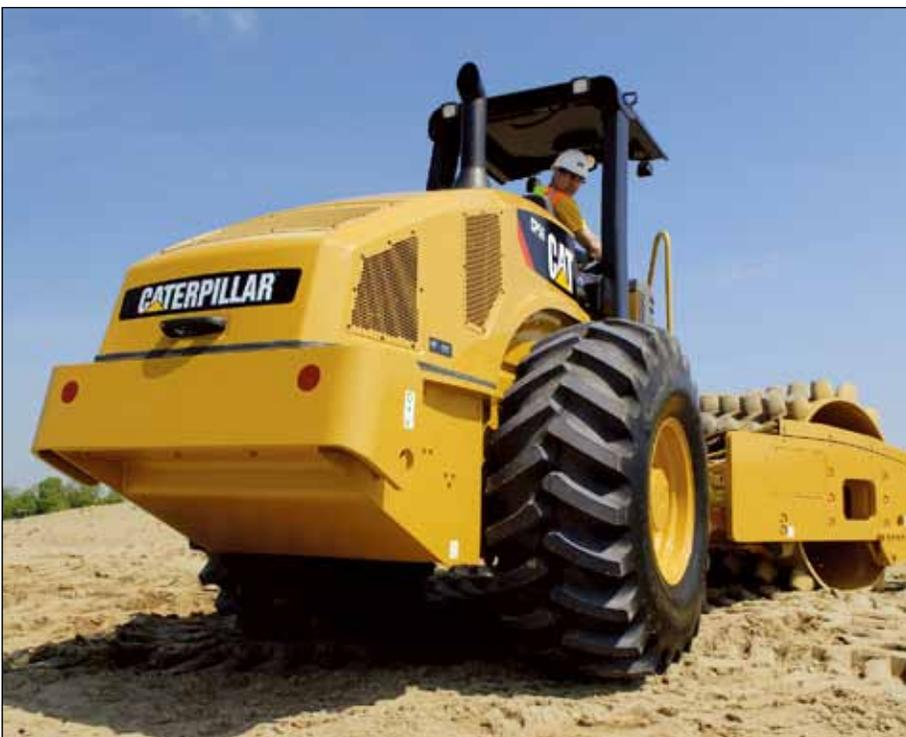
**A visibilidade traseira excepcional** proporciona linha de visão para as extremidades dos pneus e a parte traseira da máquina. O operador enxerga obstáculos medindo 1 metro (3 pés e 3 pol) de altura localizados a 1 metro (3 pés e 3 pol) da traseira da máquina. O para-lama ficou mais estreito, assim como o para-choque traseiro. A excelente visibilidade aumenta a produtividade ao trabalhar com obstruções próximas ou ao manobrar pelo canteiro de obras.
