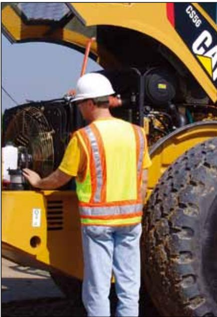
*O capô em fibra de vidro inteiriço se inclina para frente para permitir acesso ao motor e ao sistema de arrefecimento. Os pontos de manutenção diária são acessíveis a partir do nível do solo e são agrupados em um lado da máquina.*
