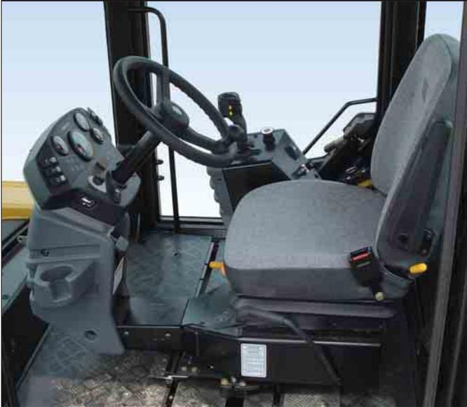
**Asiento.** Asiento cómodo y duradero que puede ajustarse longitudinalmente, así como la firmeza de la suspensión. Está equipado con apoyabrazos abatibles y un cinturón de seguridad enrollable de 76 mm de anchura.
