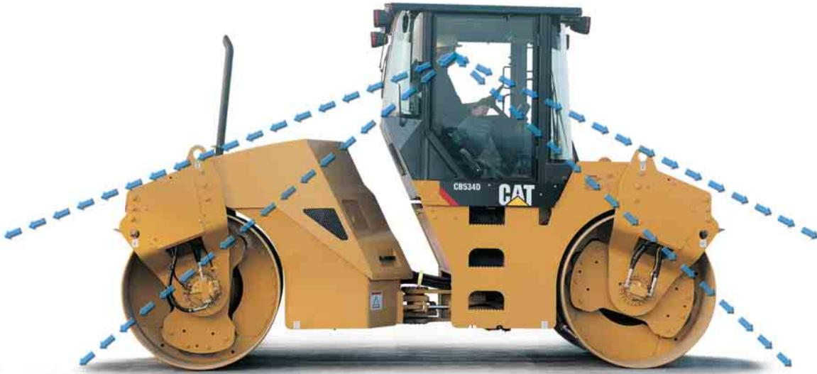
**Visibilidad.** El operador puede ver cualquier objeto de 1 metro de altura, situado a 1 metro de distancia, tanto delante como detrás de la máquina.
