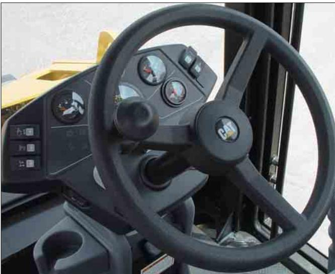
**Consola.** La consola de la dirección y los indicadores y equipos de medida pueden ajustarse infinitamente, dentro de su rango de inclinación, hasta la posición deseada por el operador. Toda la consola puede inclinarse para facilitar la entrada y salida de la máquina del operador.
