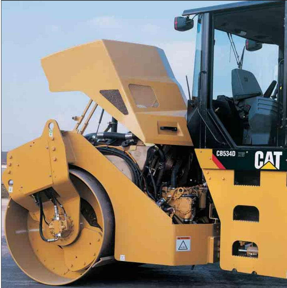
**Capó Basculante.** Un amplio capó basculante permite acceder fácilmente a los puntos de mantenimiento diario y a la parte alta del motor.
