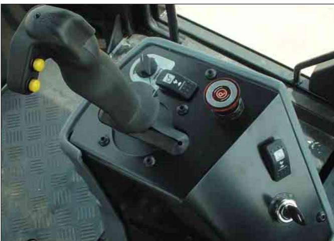
**Palanca de Propulsión.** La palanca de propulsión, multifuncional y ergonómica, facilita el manejo y conducción de la máquina. La palanca permite controlar la velocidad e incluye los mandos e interruptores de conexión/desconexión de la vibración y del sistema de riego de los tambores, la bocina y el desplazamiento del tambor trasero (opcional).
