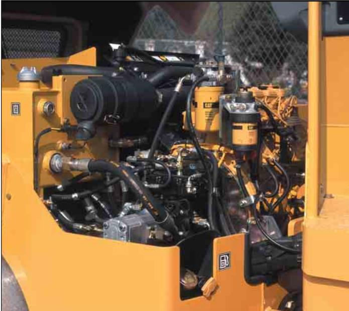
**Capó del motor.** El capó de fibra de vidrio del motor se abre basculándolo hacia arriba. Una vez abierto se sujeta con una varilla.
