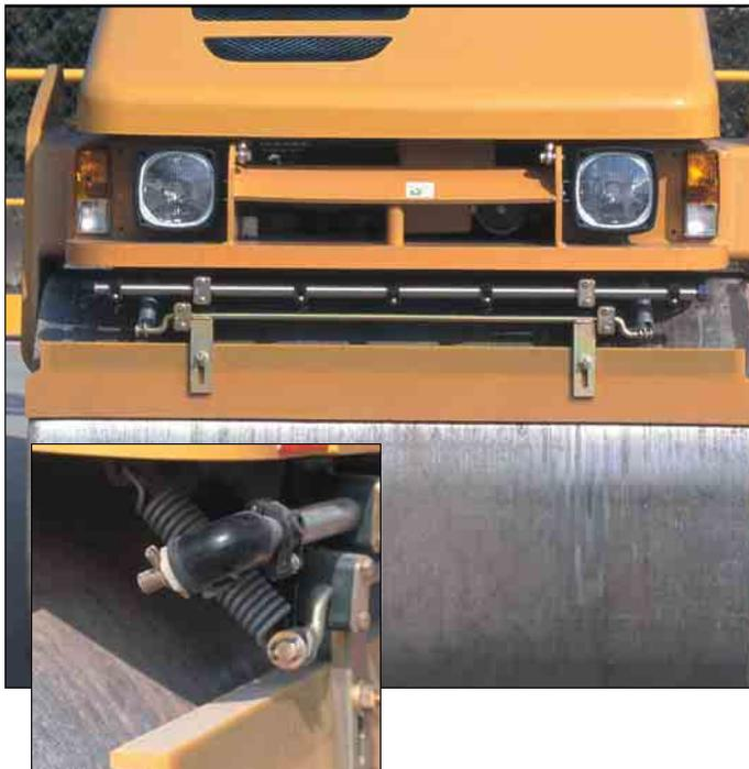
**Depósito de agua.** El sistema dispone de un depósito de agua de 300 litros encerrado dentro el bastidor de la máquina. La capacidad del depósito, que sólo tiene una boca de llenado, permite trabajar durante más tiempo.
