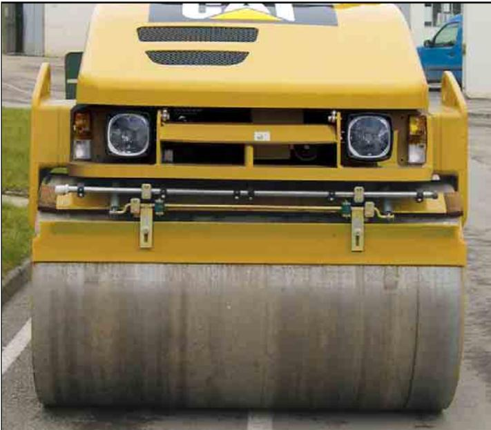
**Mayor producción.** El CB-34E XW, equipado con tambores de 1400 mm de anchura, puede realizar el trabajo en menos pasadas. Su mayor capacidad de producción cambia la forma de realizar la compactación.
