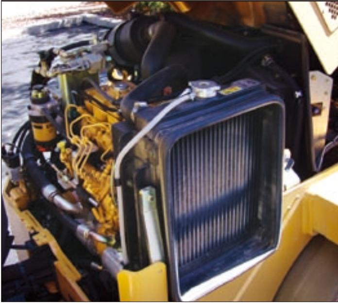
**易于保养。**垂直提升的发动机罩，便于接触发动机机油滤清器、液压滤清器、防振装置、散热器和推进泵，使日常维修保养工作更快捷。
