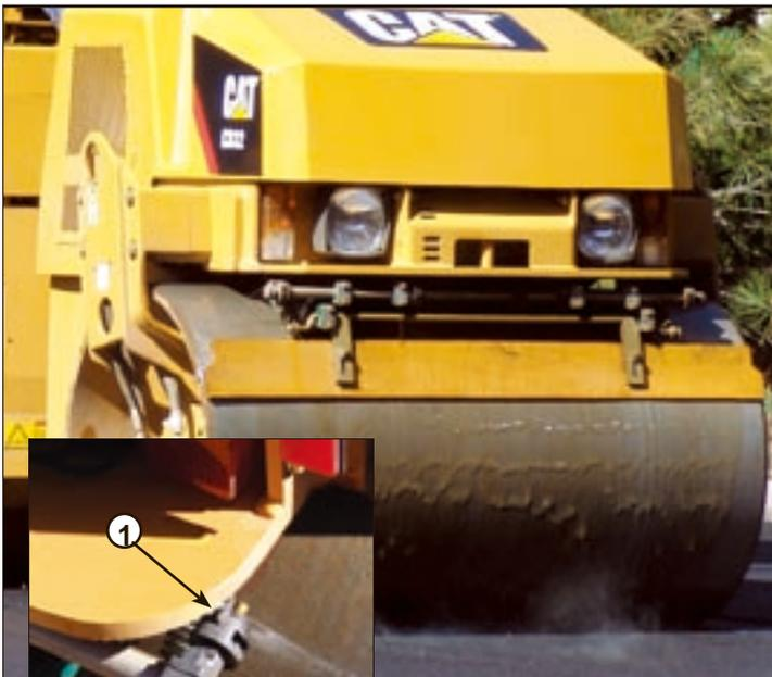
**水箱。**机架内侧安装了一个 150 升的大容量聚乙烯水箱，可延长运转时间。加上一个容量为 90 升的辅助水箱，总的水容量可达 240 升。新型排水系统能迅速排干整个系统。
