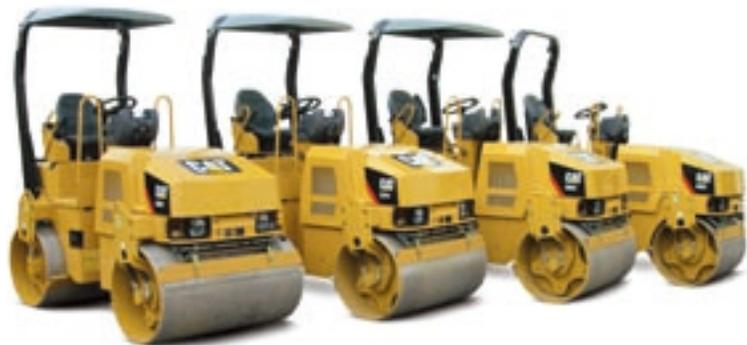
**CB22。**CB22 配备了宽度为 1.00 米的钢轮，在重量和功率之间取得了良好的平衡，可在恶劣的作业环境中实现高性能。
