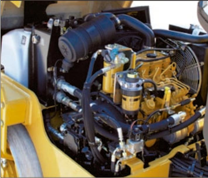
功率。C1.5 三缸液冷发动机的总功率为 24.4 千瓦（33.2 马力），在所有工作条件下均能表现出色、稳定可靠。
