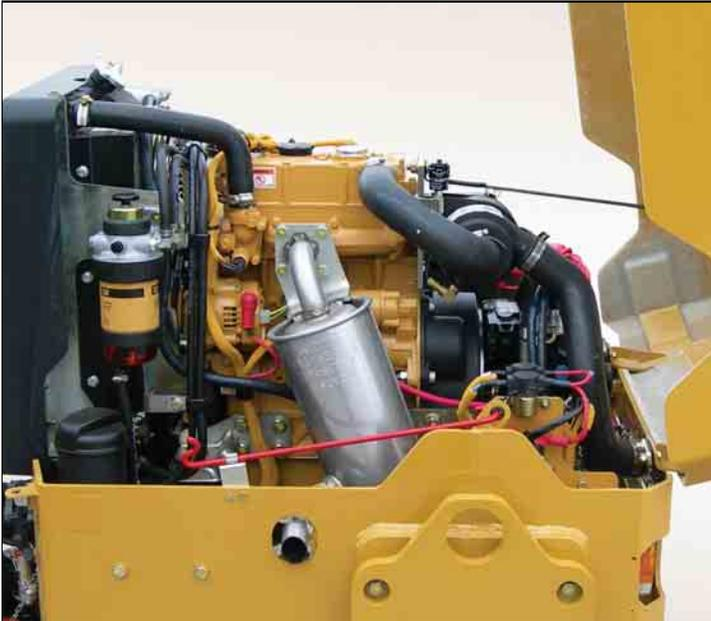
**Puissance.** Le Moteur C1.1 Caterpillar refroidi par eau développe une puissance brute de 16,1 kW (22 ch) à 2400 tr/min qui lui assure d'excellentes performances, son faible niveau sonore optimisant le confort de conduite.
