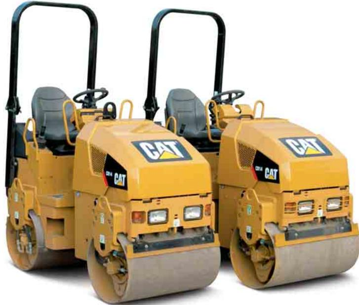
**Production accrue.** Le CB14 XW est disponible en deux versions; avec cylindres de 900 mm de large ou cylindres de 1000 mm de large. Ces deux versions permettent d'élargir la couverture du revêtement en un nombre réduit de passes qui se chevauchent.
