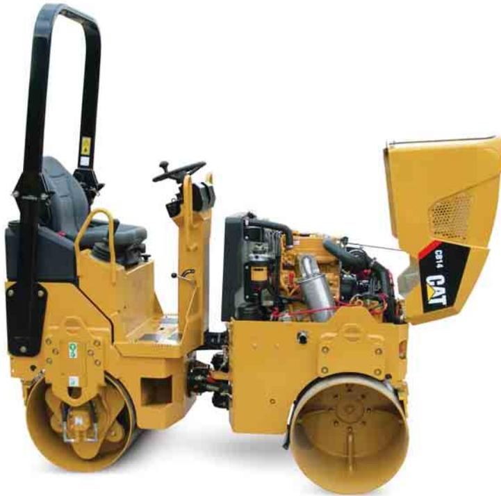
**Capot moteur.** Le capot moteur en fibre de verre pivote vers le haut et se bloque en position ouverte avec une béquille-support.
