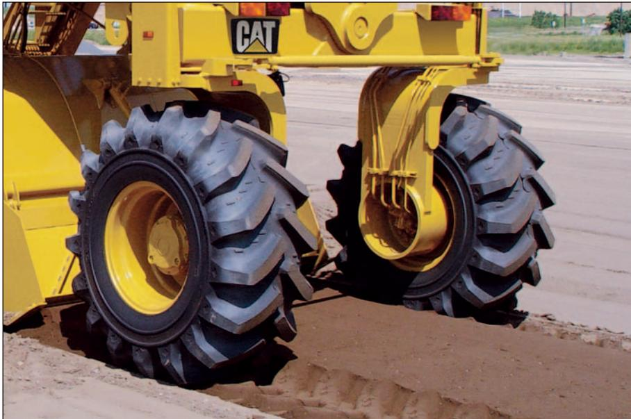
**Sistema de propulsión de doble bomba:** una bomba está dedicada a propulsar las ruedas delanteras, mientras que la segunda bomba de propulsión está dedicada a impulsar las ruedas traseras.
