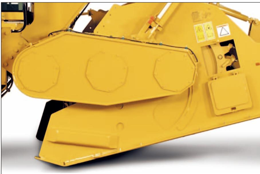
**Una servotransmisión Cat** impulsa al rotor y tiene el tamaño adecuado para manejar cortes difíciles y profundidades variadas.
