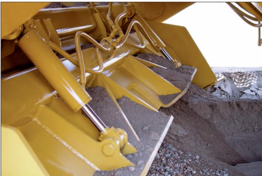
**La puerta delantera con dirección hidráulica** permite al operador controlar la apertura de la puerta delantera desde la estación del operador.
