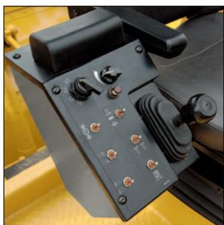
*La consola lateral cuenta con un posabrazos acolchado, el interruptor de dirección de cuatro modos, selector de control de velocidad, palanca de propulsión, elevación del rotor, interruptores de la puerta del capó del rotor delantero y trasero, interruptor de dirección trasera e interruptor de estación del operador deslizante.*
