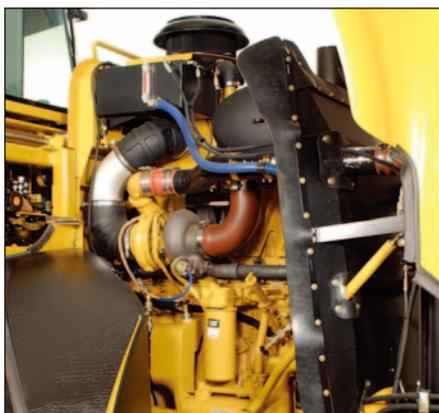
*El capó de fibra de vidrio de una sola pieza se inclina hacia adelante para ofrecer un acceso excepcional al motor y al paquete de enfriamiento. Se puede tener acceso a los puntos de servicio diarios desde el nivel del suelo y están agrupados a un lado del motor. Los paneles laterales inferiores se abren completamente para mejorar aún más el acceso.*
