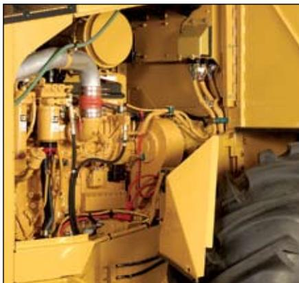
*Os pontos de manutenção diária são acessíveis a partir do nível do solo e são agrupados de um lado do motor. Os painéis laterais articulados, acessíveis sobre o nível do solo, abrem-se totalmente para proporcionar acesso aos componentes do motor. Os painéis laterais mais baixos podem ser facilmente removidos para facilitar ainda mais o acesso.*
