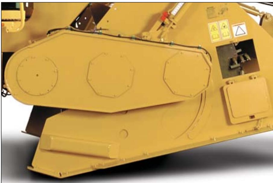
**Com a embreagem de engate hidráulico, a transmissão mecânica de alto torque e o eixo de comando**, é possível obter eficiência e confiabilidade na transferência de potência do motor para o rotor, com dimensionamento para suportar cortes difíceis e misturas profundas.
