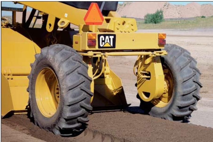
**Sistema com duas bombas de propulsão:** uma das bombas se encarrega de mover as rodas dianteiras, enquanto a outra move as rodas traseiras.
