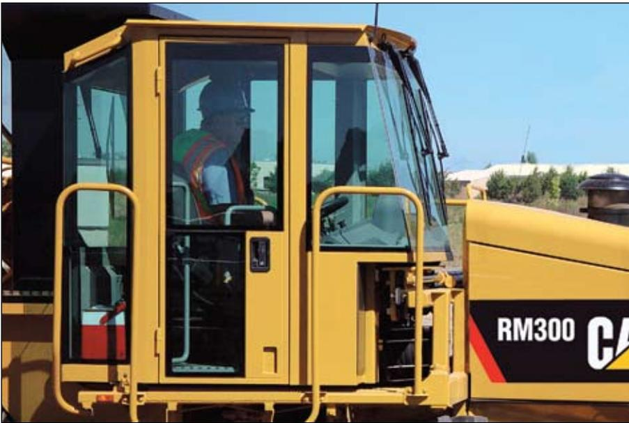
**A cabine, com suporte de isolamento, é pressurizada** a fim de impedir a entrada de ruído, poeira e intempéries, e de preservar o conforto.
