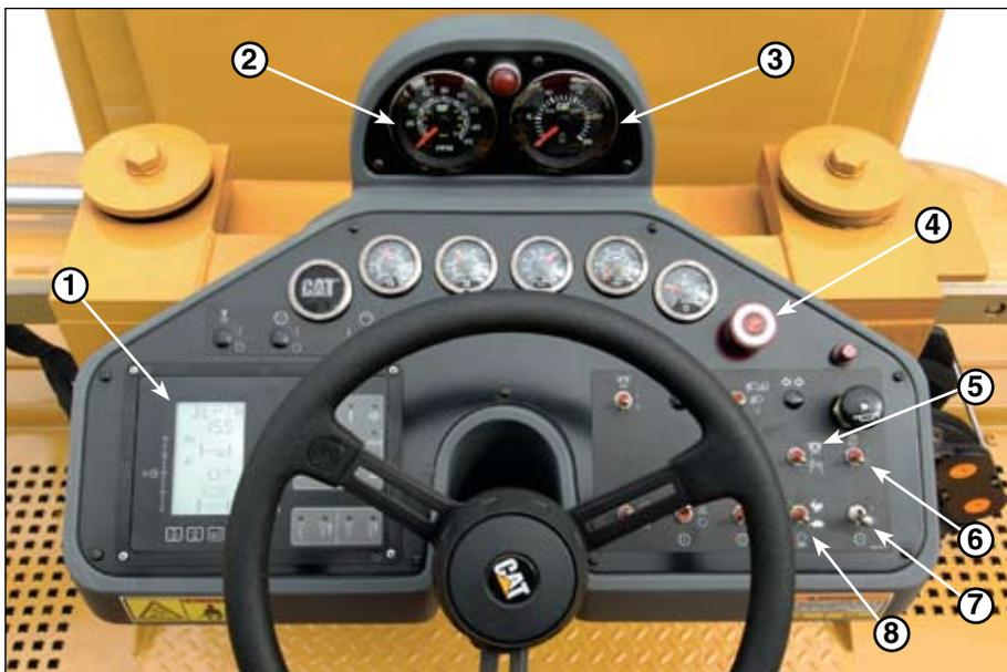
**Entre os acessórios fornecidos como forma de ter uma instrumentação clara e nítida** estão os medidores da pressão do óleo do motor, da temperatura do líquido arrefecedor do motor, da temperatura do óleo hidráulico, da tensão do sistema de carga e do nível de combustível.
