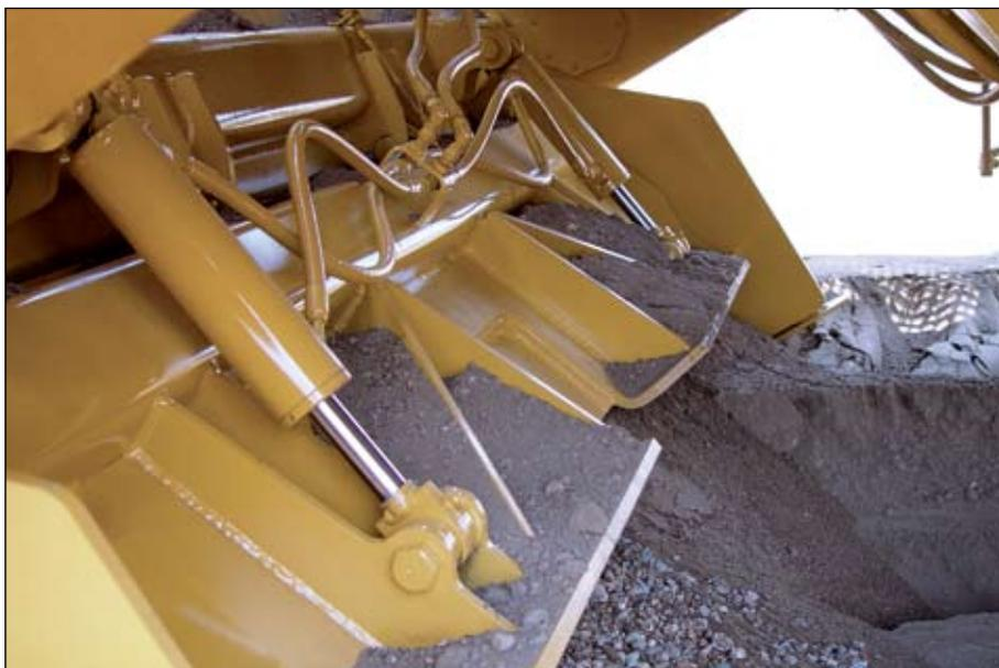
Operada hidráulicamente, a porta dianteira permite que o operador controle a abertura da porta de dentro do seu posto.
