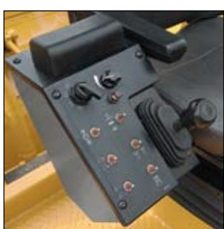
*O console lateral conta com um apoio de braço almofadado, interruptor de direção com quatro modos, botão de controle de velocidade, alavanca de propulsão, elevação do rotor, interruptores da porta dianteira e traseira do capô do rotor, interruptor de direção traseira e interruptor deslizante do posto do operador.*
