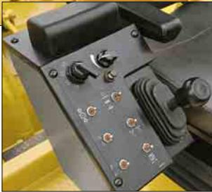
La consola lateral incluye un posabrazos almohadillado, el interruptor de los cuatro modos de dirección, el dial de control de velocidad, la palanca de propulsión, la de elevación del rotor, los interruptores de las compuertas del rotor, delantera y trasera, de la dirección trasera y de la plataforma deslizante del operador.
