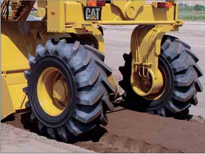
**Sistema de propulsión de dos bombas.** Una bomba acciona las ruedas delanteras mientras la segunda lo hace con las ruedas traseras.
