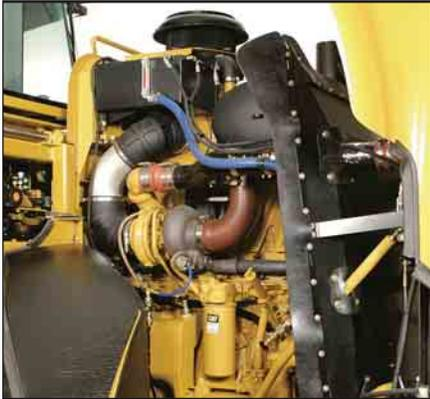
*El capó de fibra de vidrio de una sola pieza, que bascula hacia adelante, permite acceder cómodamente al motor y al sistema de refrigeración.*
