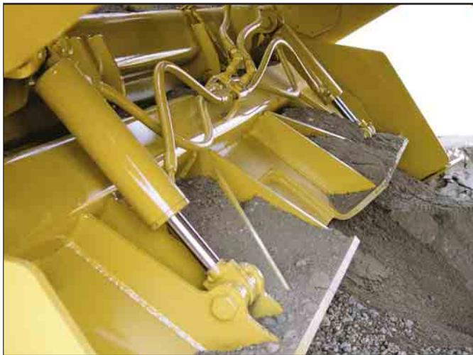
**Compuerta delantera accionada hidráulicamente.** Permite controlar la abertura de la compuerta delantera desde el puesto del operador.
