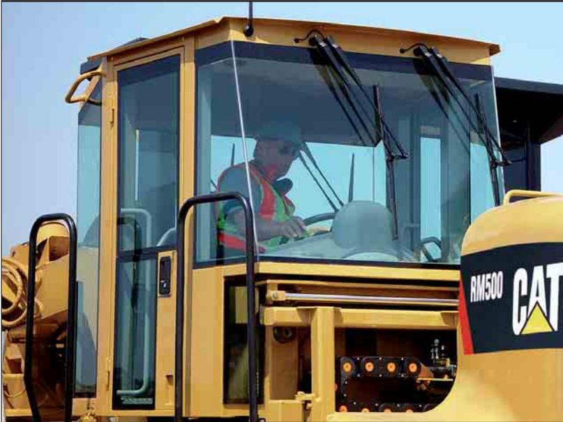
**Cabina aislada y presurizada.** Impide la entrada de ruido, polvo y otros elementos dentro de la cabina, para mayor comodidad en su interior.
