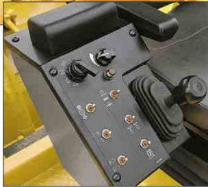
На боковой панели находится подлокотник с обивкой, переключатель четырехрежимной системы рулевого управления, регулятор частоты вращения коленчатого вала, рычаг хода, переключатели подъема ротора, выключатель переднего и заднего лючков капота ротора, выключатель задней системы рулевого управления и переключатель, управляющий движением платформы оператора.
