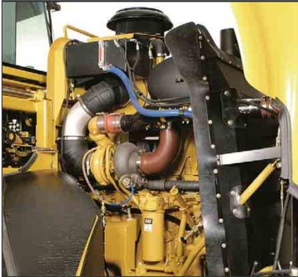
Цельный капот из стекловолокна откидывается вперед и обеспечивает отличный доступ к двигателю и деталям системы охлаждения. Точки ежедневного обслуживания сгруппированы с одной стороны двигателя и доступны с уровня земли. Нижние боковые люки широко открываются, обеспечивая более удобный доступ.
