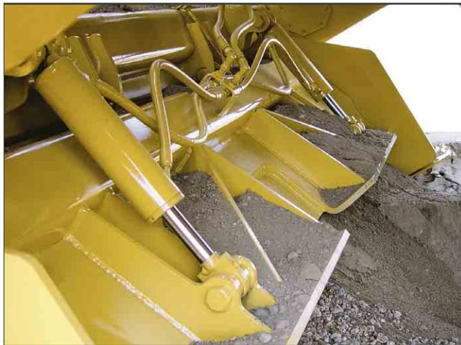
**Передняя дверца с гидравлическим приводом.** Система гидравлического привода позволяет регулировать положение передней дверцы с рабочего места оператора.
