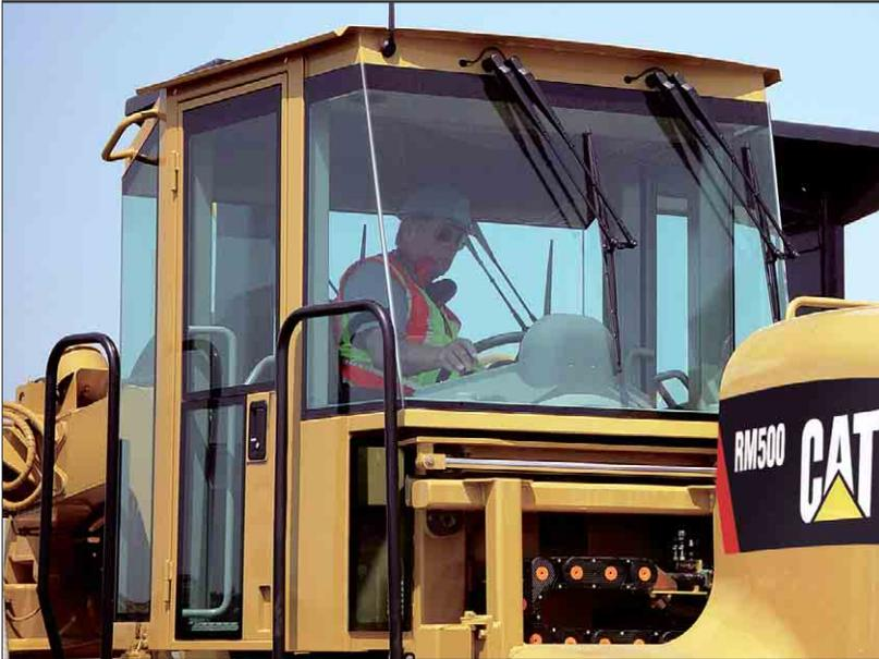
**Кабина с наддувом, установленная на демпфирующих опорах.** В комфортной, шумоизолированной и герметизированной кабине созданы прекрасные условия для работы.
