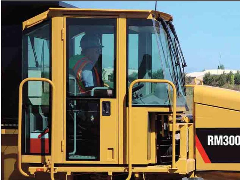
**Serienausstattung.** Die umfangreiche Serienausstattung der Fahrerkabine umfasst zwei abschließbare Türen, Klimaanlage, Druckbelüftung, Drehsitz mit Textilbezug, Blendschutzglas in allen Fenstern, Front- und Heckscheibenwischer, schalldämmende Fußmatte, zwei Getränkehalter und 12-V-Steckdose.
