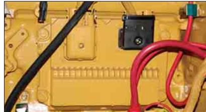
**Motorblock.** Um die bestmögliche Robustheit und Steifigkeit zu erzielen, ist der Graugussblock aus einem Stück gegossen und mit groß dimensionierten, internen Verstärkungsrippen versehen, sodass er die angestiegene Verdichtung problemlos verkraftet. Integrierte O-Ring-Verbindungen sorgen für dauerhafte Dichtigkeit.
