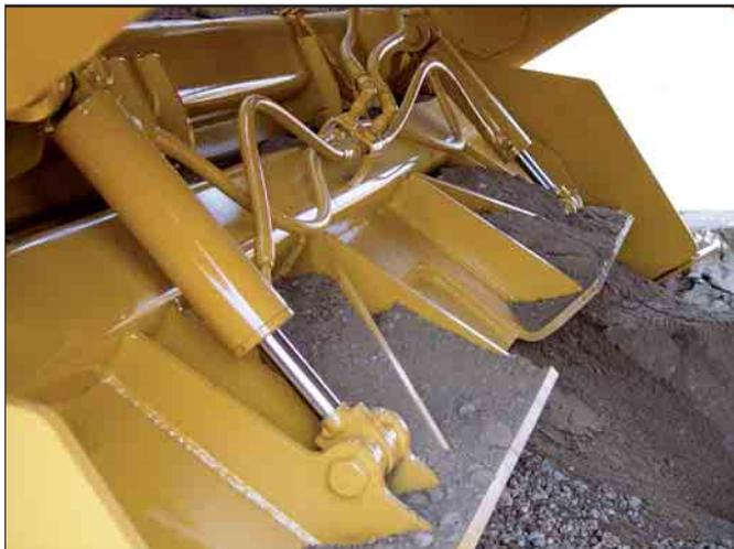
**Hydraulikzylinder.** Zum Heben und Senken der Frontklappe sind zwei Hydraulikzylinder vorhanden, die eine präzise Positionierung ermöglichen.
