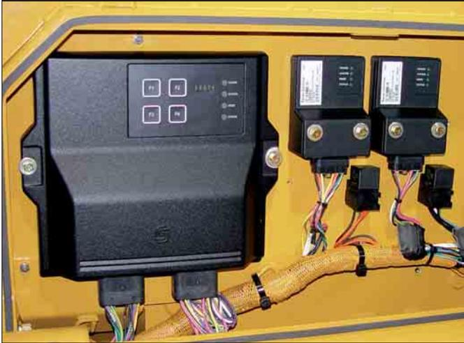
**Signalverarbeitung.** Im elektronischen Steuergerät werden die vom Dieselmotor, Fahrtrieb, Rotorantrieb und Lenksystem eingehenden Signale permanent ausgewertet.
