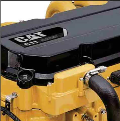
**Umweltverträglichkeit.** Der schadstoffarme, elektronisch gesteuerte Sechszylindermotor C11 folgt dem von Caterpillar entwickelten ACERT-Konzept und unterschreitet die Abgasemissions-Grenzwerte gemäß EU-Richtlinie 97/68/EG, Stufe IIIA.
