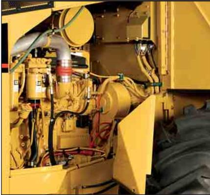
Alle täglichen Wartungsarbeiten sind bequem vom Boden aus durchführbar. Seitenklappen bieten freien Zugriff auf die Bauteile des Dieselmotors. Zusätzlich lassen sich die unteren Klappen komplett entfernen.
