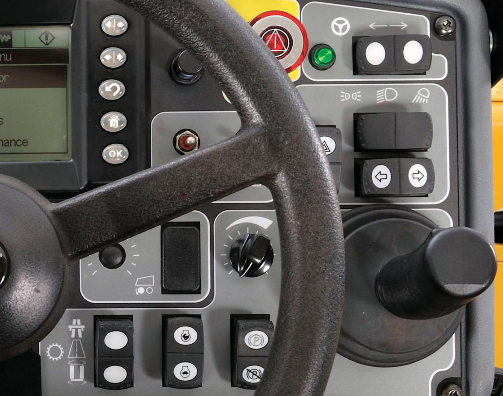
*Las consolas de operación Cat® utilizan interruptores de retroalimentación positiva; la sensación de la activación con la punta de los dedos aumenta la confianza del operador.*
