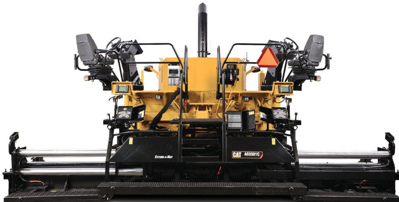
*Los tubos de soporte de servicio pesado estabilizan los extensores y así suministran un flujo de materiales uniforme para obtener resultados de alta calidad en carreteras interestatales, aeropuertos y otras aplicaciones de pavimentación de alta producción.*
