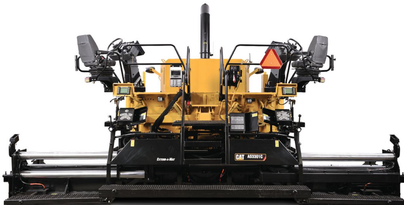
*Tubos de apoio reforçados dão estabilidade aos extensores proporcionando um fluxo uniforme de materiais com resultados de alta qualidade em estradas, aeroportos e outras aplicações de pavimentação de alta produção.*
