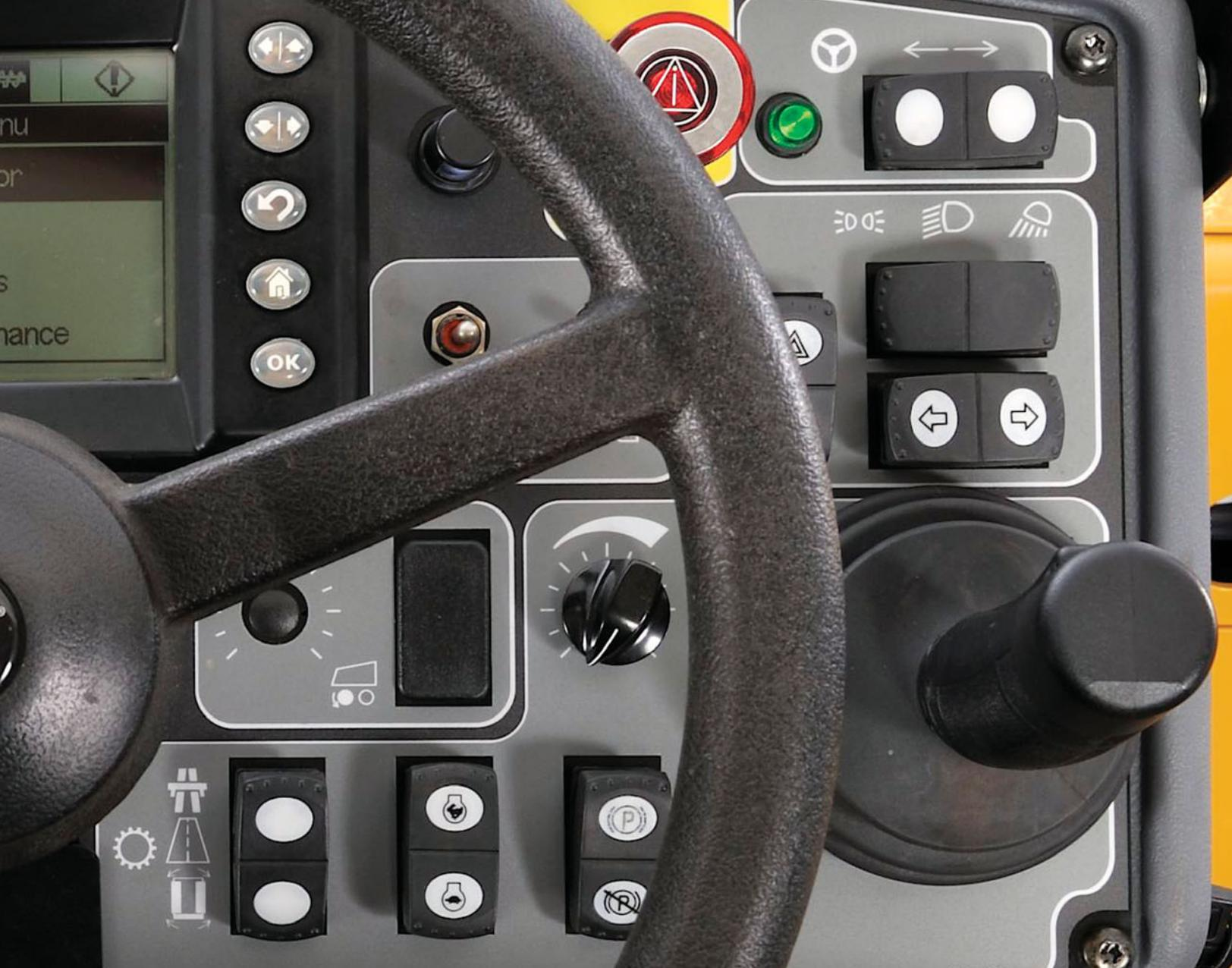
*Os consoles de operação Cat® utilizam interruptores positivos de feedback; a sensação da ativação com a ponta dos dedos promove a confiança do operador.*
