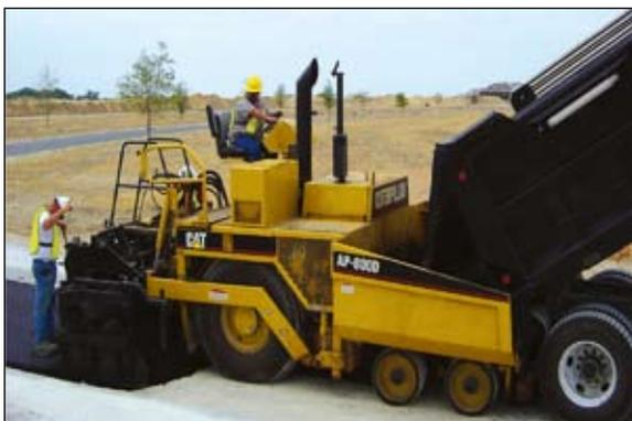
**Pavimentadora de Asfalto de Rodas AP-800D**
