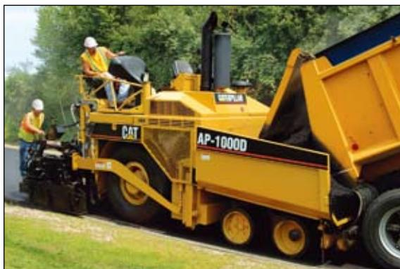
**Pavimentadora de Asfalto de Rodas AP-1000D**
