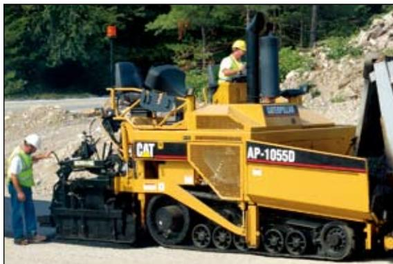
**Pavimentadora de Asfalto AP-1055D com Mobil-trac™**
